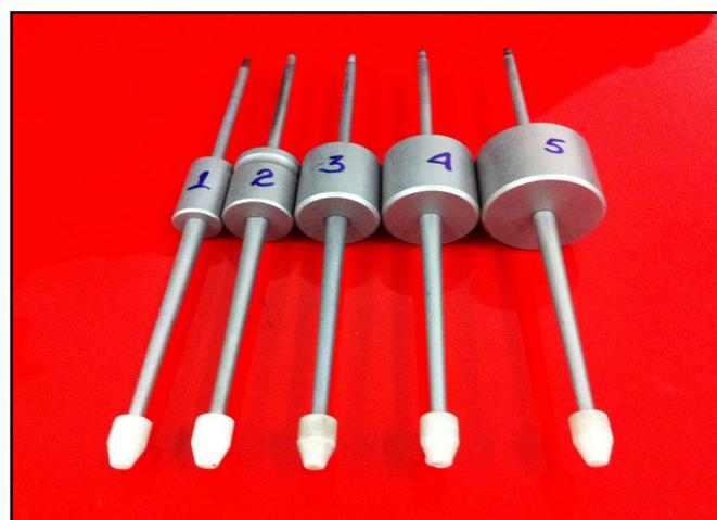
**Figura 4** – Dispositivos BCP-bate conexão com 5 pesos diferentes (Kopp®, Curitiba, Brasil)
