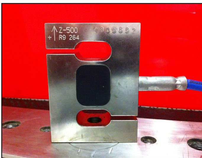
**Figura 3** - Célula de carga (Modelo CCE5KN; Emic)
