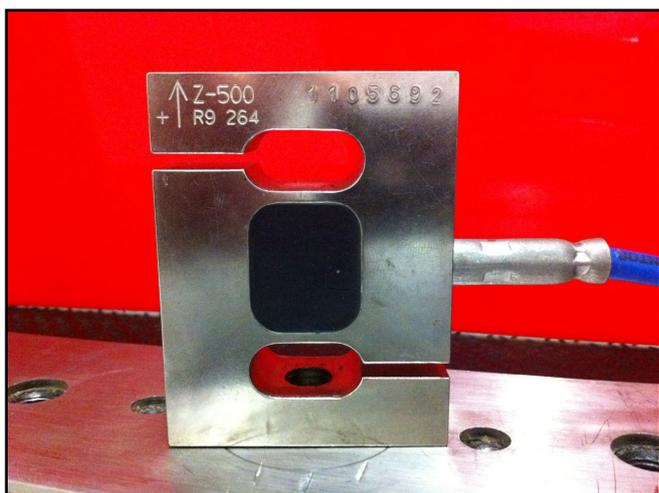
**Figura 5** - Célula de carga
