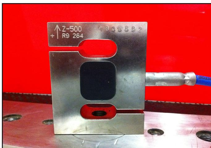
**Figura 3** - Célula de carga (Modelo CCE5KN; Emic)
