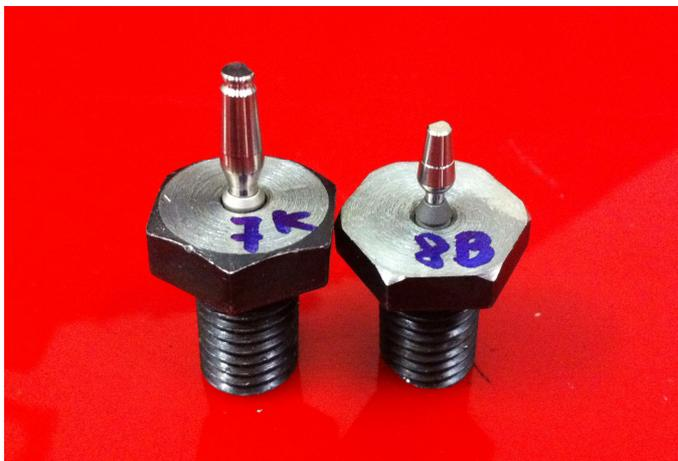
**Figura 1** - Implante e intermediário Kopp<sup>®</sup> e Bicon<sup>™</sup> fixados em uma base Rígida
