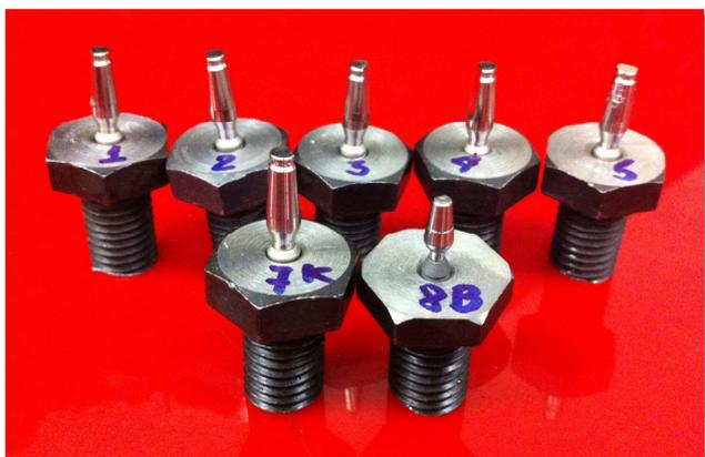
**Figura 3** - Conjuntos implante e intermediário fixados em uma base rígida
