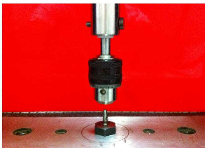
**Figura 6** - Pinça ou mandril adaptado à célula de carga
