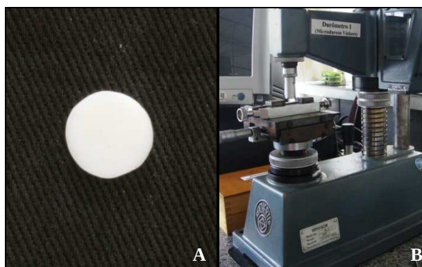
Figura 6: Teste de Microdureza de Vickers. (A) Corpos de prova. (B) Análise da dureza no microdurômetro com a ponta do tipo Vickers.
