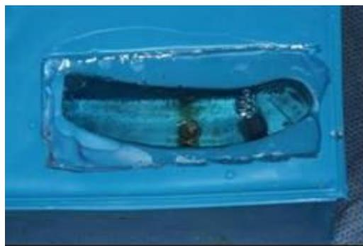
Figura 4: vazamento com resina fotoelástica
