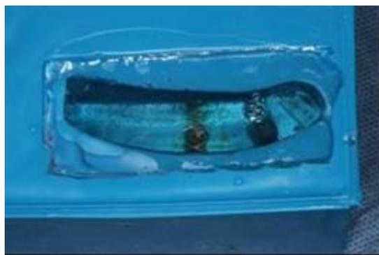
Figura 5 – Molde de silicona preenchido com a resina fotoelástica.
