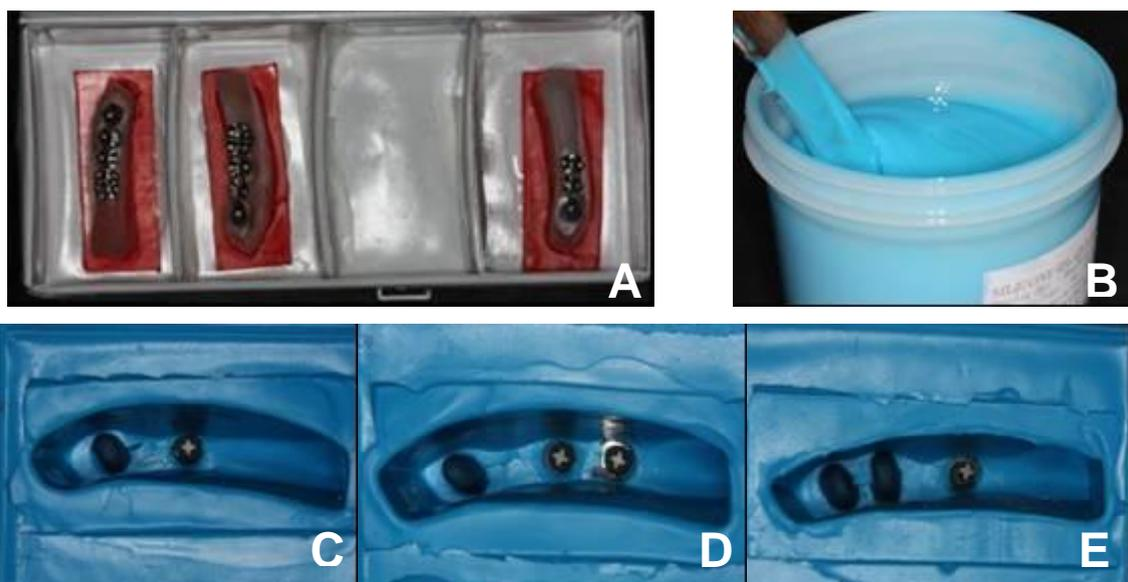
Figura 4 – Recipiente para moldagem dos modelos (A); manipulação da silicona industrial (B); moldes com os conjuntos pilares/próteses em seu interior (C, D e E).
