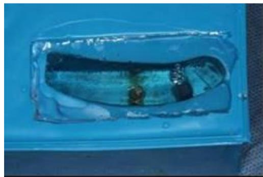
Figura 4: vazamento com resina fotoelástica
