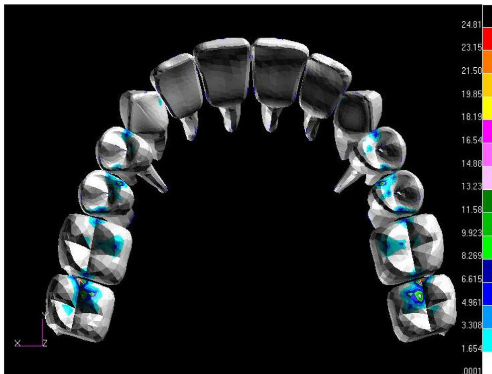
Figura 18 - MEF 1: Contatos padrão tensão Von Misses arco superior.
