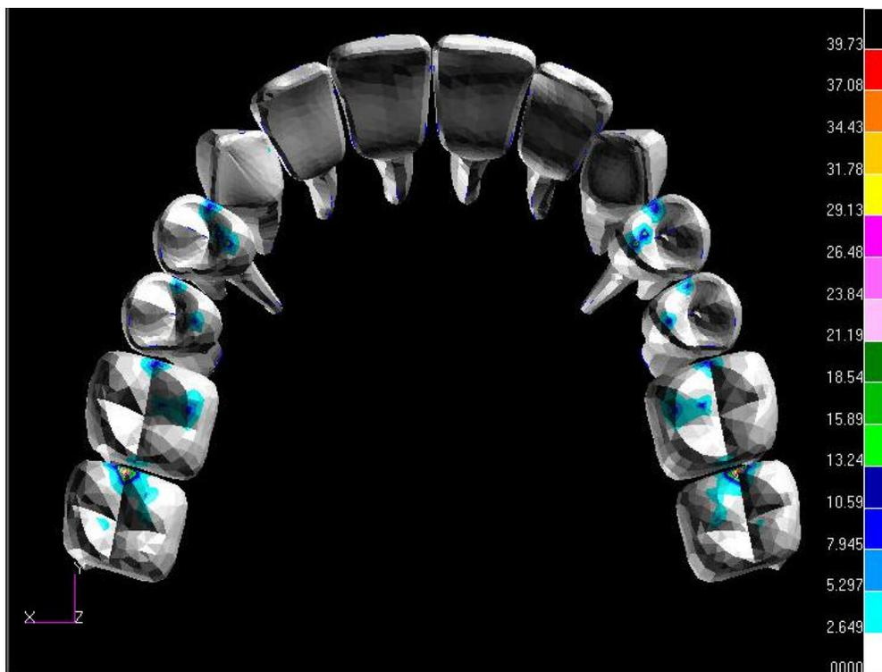
Figura 44 – MEF 2 - Contatos de equilíbrio, tensão Von Misses, vista oclusal dos superiores.
