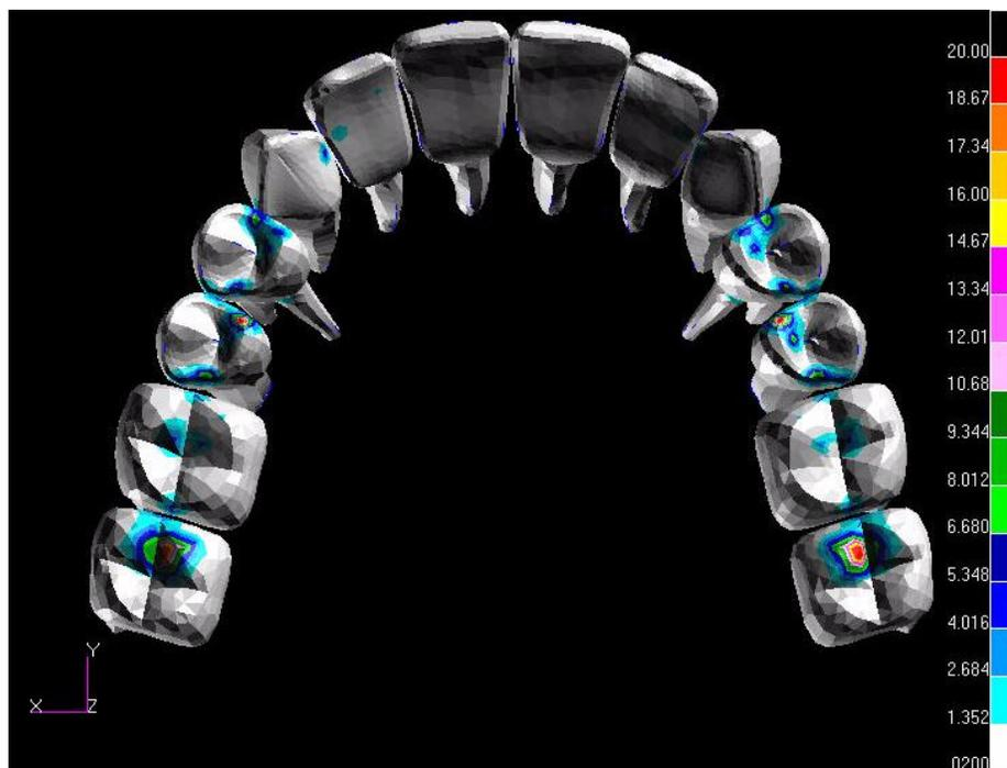
Figura 79 –MEF 4 – contatos de arada e incisivos com contato, tensão Von Misses.
