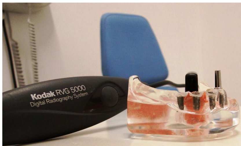
Figura 1: Modelo de acrílico edêntula com implantes. Note-se, ainda, o sensor CCD.
