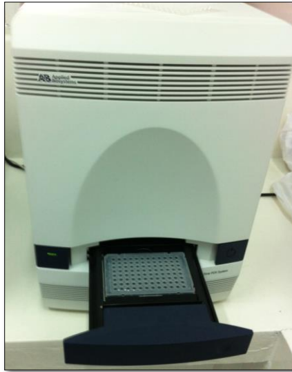
Figura 3: Mini placa com amostras no Termociclador.
