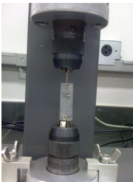
Figura 4 – Realização do ensaio de atrito.
