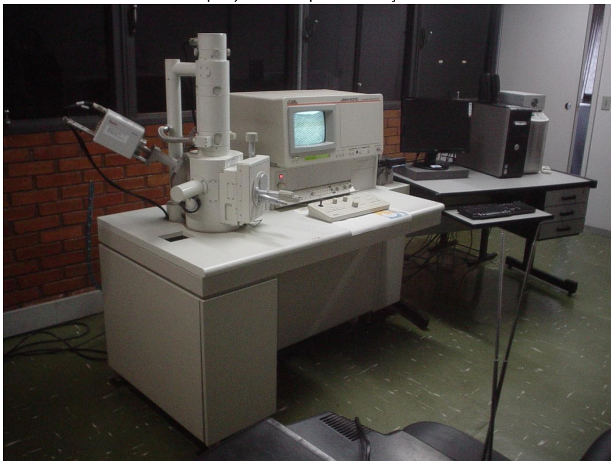
Figura 1 – Microscópio eletrônico de varredura (MEV) JSM-5310 (JEOL, Tokyo, Japan) utilizado para avaliações.
