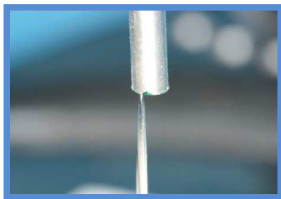
Figura 22 - Ajuste padronizado do tamanho da agulha eixos X, Y e Z
