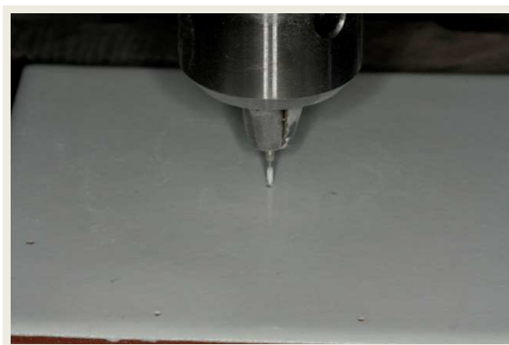
Figura 20 – Perforação com broca 1557 em placa de cerâmica para a fixação das agulhas referenciais fixas.
