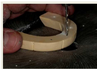
Figura 7 – Perfuração para a fixação dos pinos metálicos
