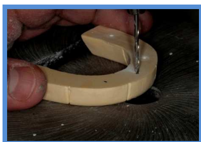
Figura 5 - Perfuração para a fixação dos pinos metálicos
