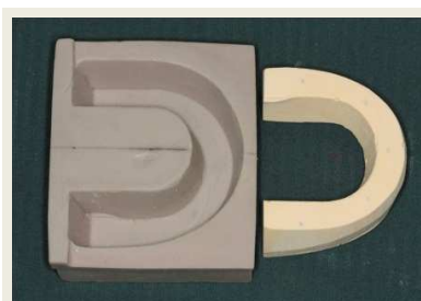
Figura 15 – Modelo padrão troquelizado.
