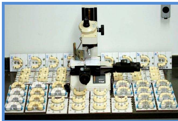
Figura 27 - Microscópio medidor e 50 corpos de prova medidos (3.200 medições)
