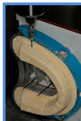
Figura 17 - Perfuração com broca 1557 em modelo padrão para a fixação de agulhas referenciais removíveis para o eixo Z
