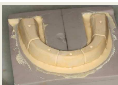
Figura 14 – Vazamento de base de gesso do corpo de prova.
