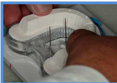
Figura 20 - Fixação do modelo padronizado em posição pré-determinada Fonte: Elaborado pelo autor
