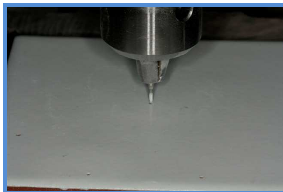
Figura 18 - Perfuração com broca 1557 em placa de cerâmica para a fixação das agulhas referenciais fixas Fonte: Elaborado pelo autor
