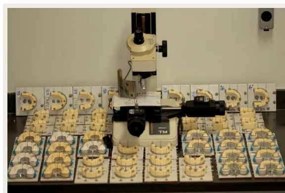
Figura 30 – Microscópio medidor e 50 corpos de prova medidos (3.200 medições).
