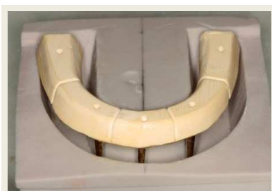
Figura 13 – Modelo padrão pronto para vazamento de base de gesso em molde de silicone.
