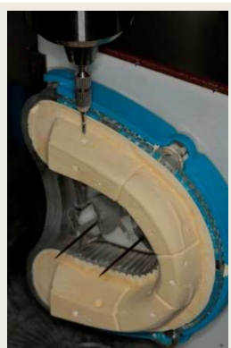
Figura 18 – Perforação com broca 1557 em modelo padrão para a fixação de agulhas referenciais removíveis para o eixo Z
