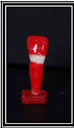
Figura 16: Espécime posicionado pelo ápice com a segunda camada do material impermeabilizador (esmalte Risqué), exceto área de cimentação Fonte: Dados da pesquisa/2007
