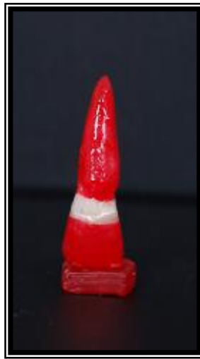
Figura 18: Espécime posicionado pela coroa provisória com a camada do esmalte Risqué na região apical da raiz. Fonte: Dados da pesquisa/2007
