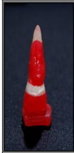
Figura 17: Espécime posicionado pela coroa provisória com as camadas de Araldite na região apical da raiz. Fonte: Dados da pesquisa/2007
