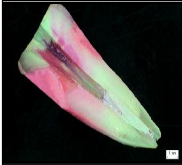
Figura 27: Imagem da infiltração de corante sob lupa estereomicroscópica com aumento de 9 vezes - cimento Lysanda. Fonte: Dados da pesquisa/2007
