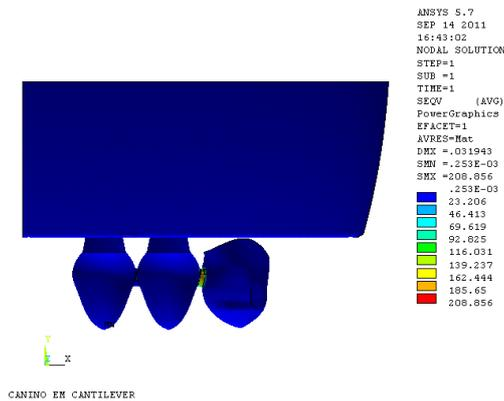
**Figura 32** - Deslocamento horizontal modelo completo mostrando as tensões SEQV
