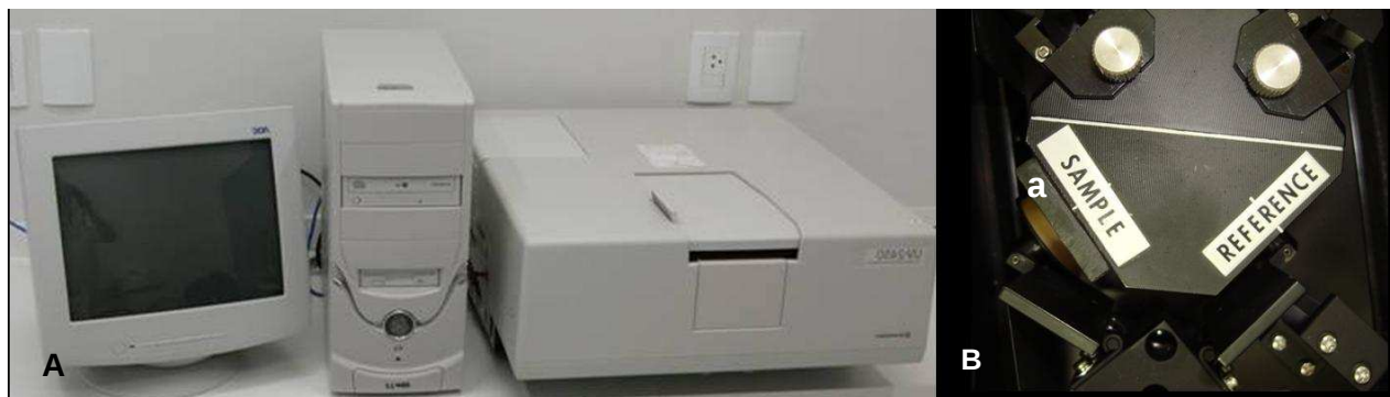
Figura 5: A- Vista externa do espectrofotômetro de reflectância ; B- Vista interna do espectrofotômetro de reflectância. (a) dispositivo metálico encaixado no espectrofotômetro.
