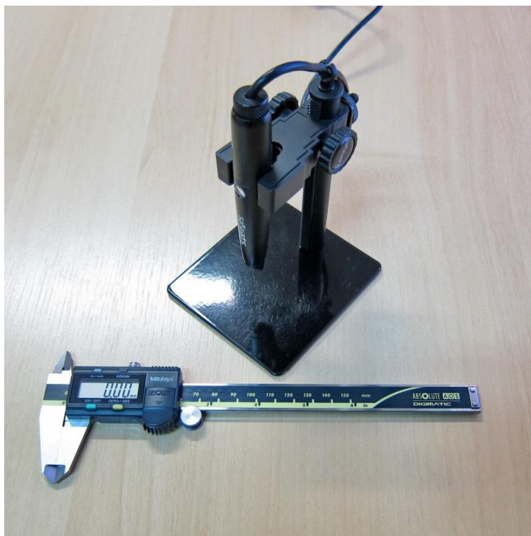
Figura 4: Microscópio digital e paquímetro digital utilizados no trabalho.
