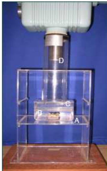
Figura 4: Dispositivo de acrílico para padronização da técnica do paralelismo: plano inferior do dispositivo de acrílico (A) , bloco ósseo/ incisivo (B) , recipiente de acrílico contendo água (C) , cilindro do aparelho radiográfico (D) .
