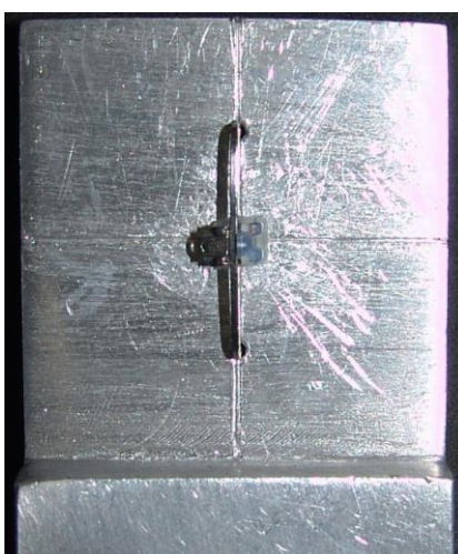
Figura 6: Dispositivo de fio de aço 0.021 x 0.025" em forma de "U" utilizado para colagem dos bráquetes.
