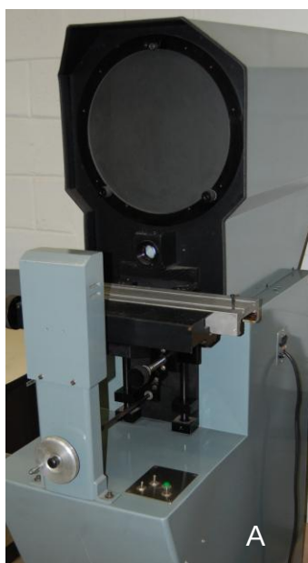
Figura 8: Projetor de perfil (A); Projeção do segmento de fio para conferência do longo eixo do gancho (B).
