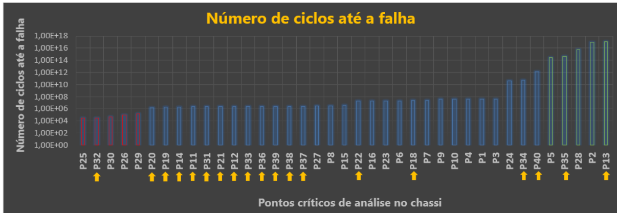
Imagem 56 - Ranking dos pontos críticos do chassi do caminhão fora de estrada
