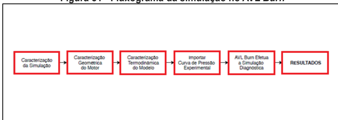
Figura 31 - Fluxograma da simulação no AVL Burn
