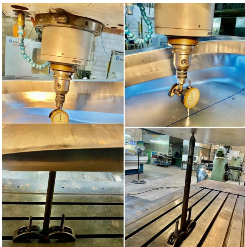
Figura 24 – Conjunto de medição montado em fresadora CNC
