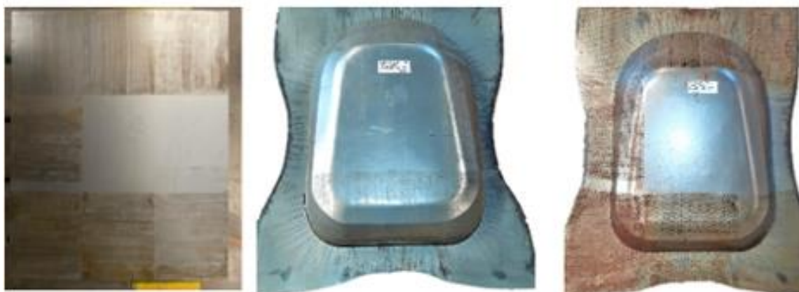
Figura 23 – Corpos de prova para obtenção da CLC a partir do embutimento real
