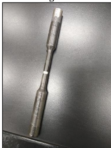
Figura 15 - Corpo-de-prova revestido com fita isolante para concentrar o ataque químico na região determinada
