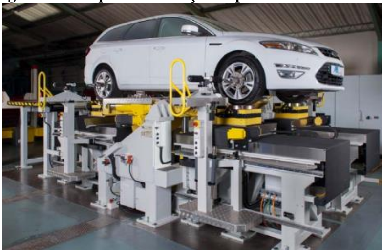
Figura 25 - Máquina de medição de parâmetros cinemáticos
