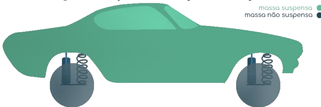
Figura 4 – Relação de massas suspensa e não suspensa
