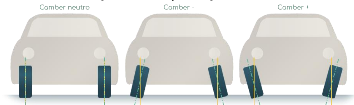
Figura 18 - Orientação do ângulo de camber
