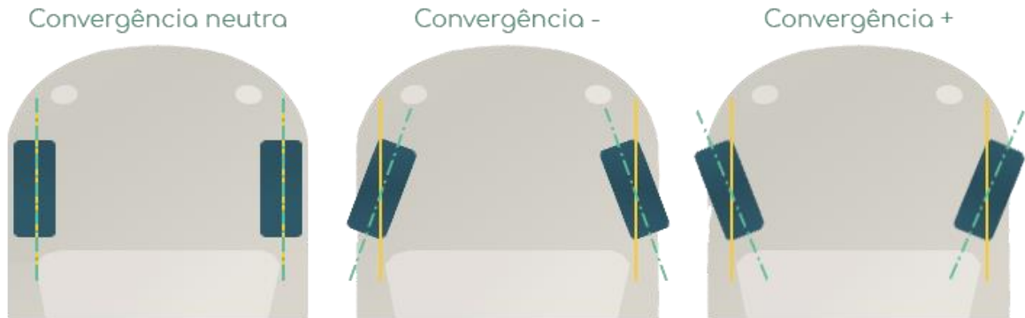
Figura 17 – Orientação do ângulo de convergência
