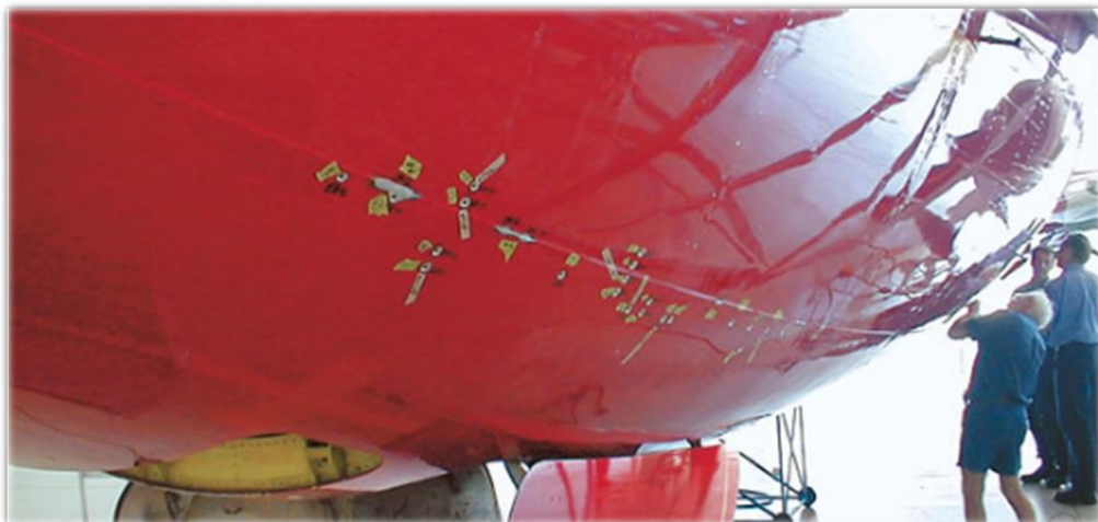
Figura 12 - Danos causados pelo efeito swept na fuselagem de um Boeing 737NG
