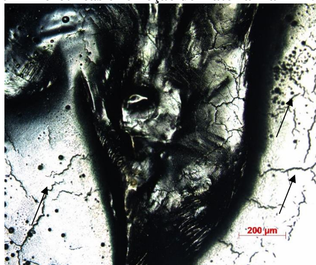
Figura 30 – Microtrincas e remoção de material na DDN2 ampliação 50X
