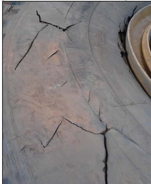
Figura 12- Trincas na parede lateral e erosões na região de assentamento do talão
