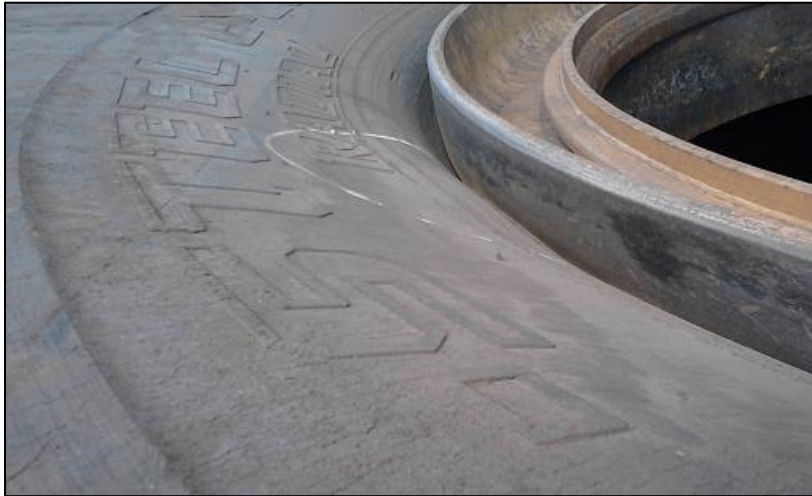
Figura 11- Separação entre a borracha e carcaça na parede lateral de um pneu
