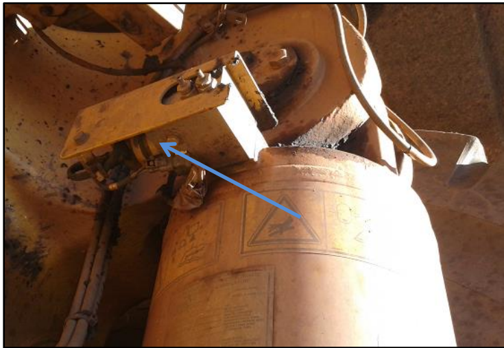
Figura 20- Sensor de pressão instalado na suspensão do equipamento
