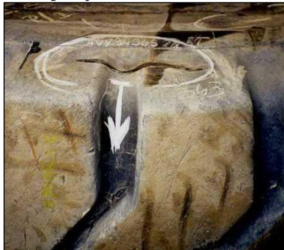
Figura 10- Separação mecânica entre as lonas do pneu
