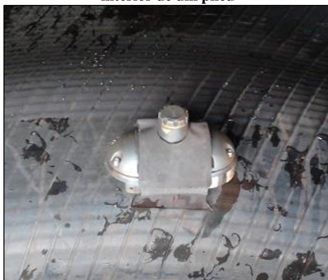
Figura 14- Sensor de monitoramento de pressão e temperatura interna instalado no interior de um pneu
