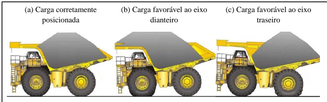
Figura 17- Exemplo de posicionamentos de carga no caminhão que influenciam no movimento de arfagem
