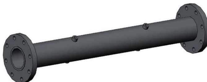
Figura 26– Vista dos orifícios de instrumentação do tubo de choque.
