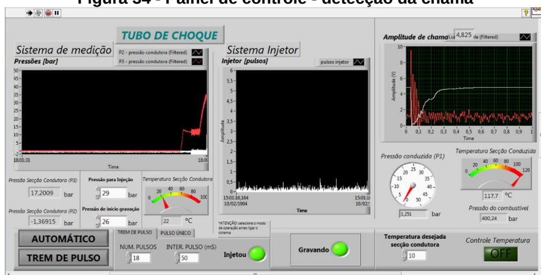
Figura 34 - Painel de controle - detecção da chama
