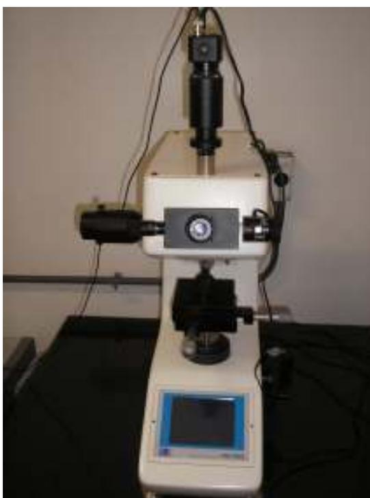
Figura 52: Durômetro usado no ensaio de micro-dureza.
