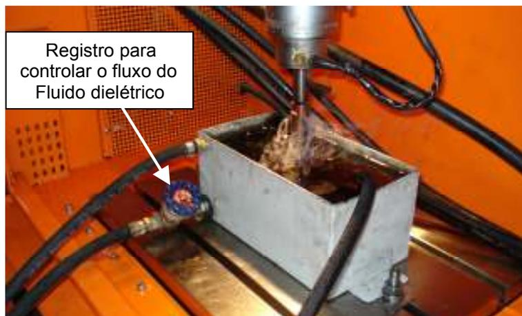
Figura 33: Cuba auxiliar, de tamanho reduzido, adaptada ao sistema.
