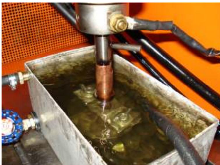
Figura 37: Agitação do fluido dielétrico no interior da cuba auxiliar.
