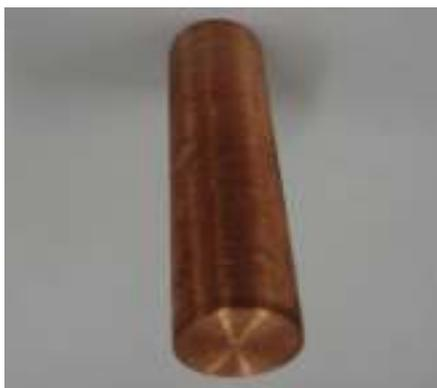
Figura 44: Eletrodo ferramenta de cobre eletrolítico.
