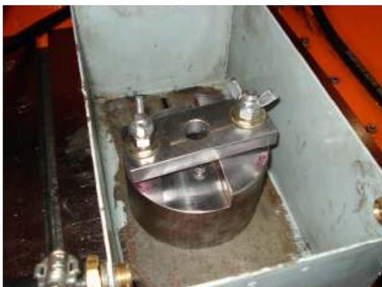
Figura 36: Dispositivo para fixação das amostras durante a usinagem, instalado na cuba auxiliar.
