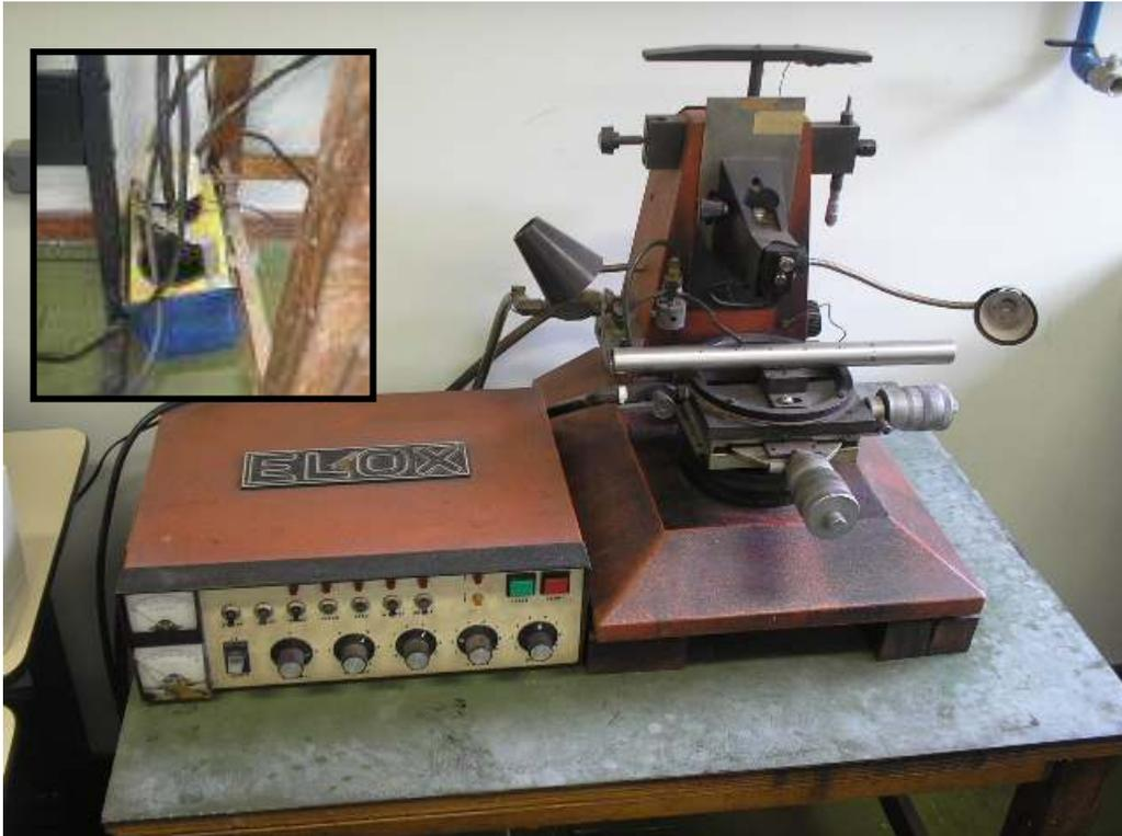
Figura 39: Máquina de eletroerosão da década de 60, que trabalha sobre uma mesa, no detalhe, o sistema de filtragem, que fica posicionado sob a mesa.
