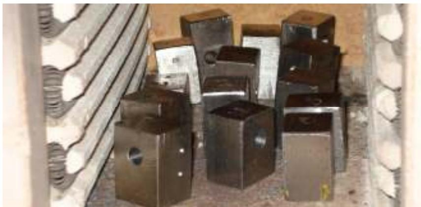
Figura 42: Amostras em tratamento térmico no interior do forno elétrico.
