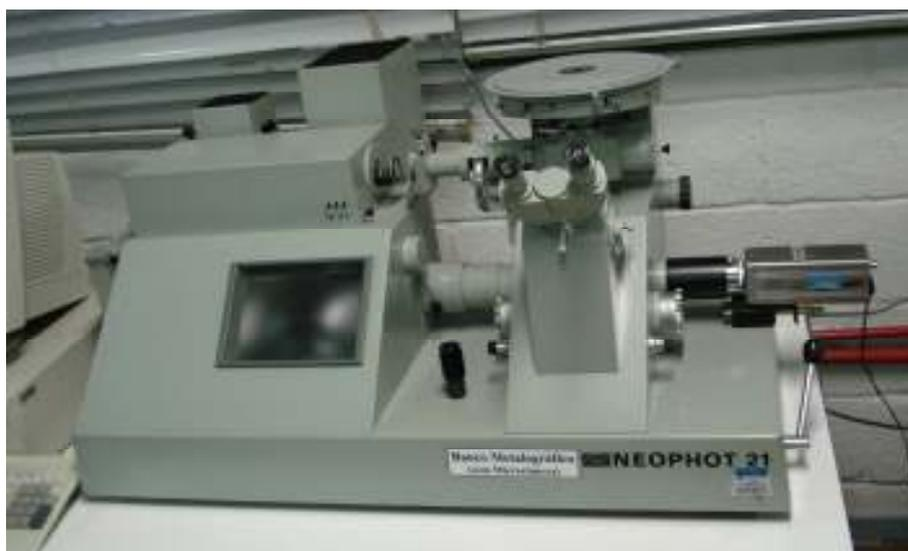
Figura 50: Banco metalográfico Neophot 21.
