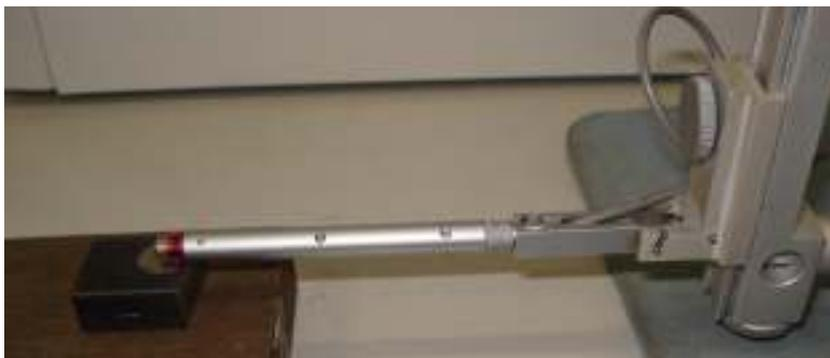
Figura 47: Medição de rugosidade no fundo da cavidade da amostra usinada no regime de acabamento.
