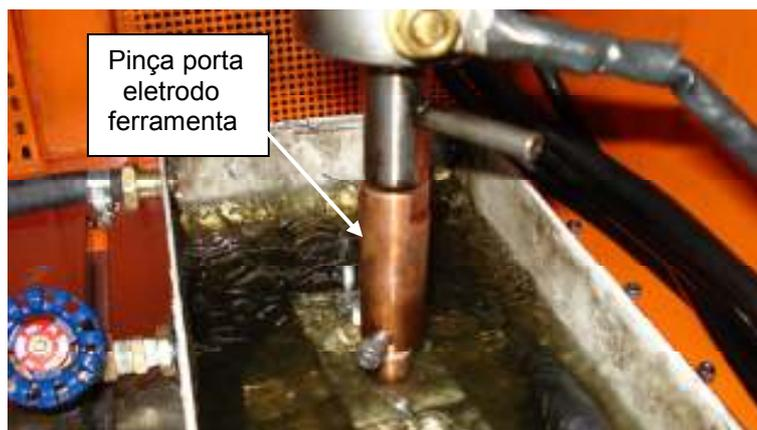
Figura 45: Montagem do eletrodo ferramenta de cobre eletrolítico na pinça porta ferramenta.
