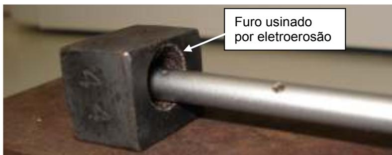
Figura 41: Rugosímetro Taylor Hobson, modelo Surtronic 3+, medindo a rugosidade na periferia do furo usinado no regime de desbaste.
