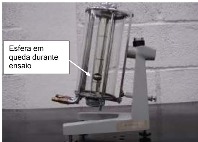
Figura 31: Viscosímetro de Hüppler.
