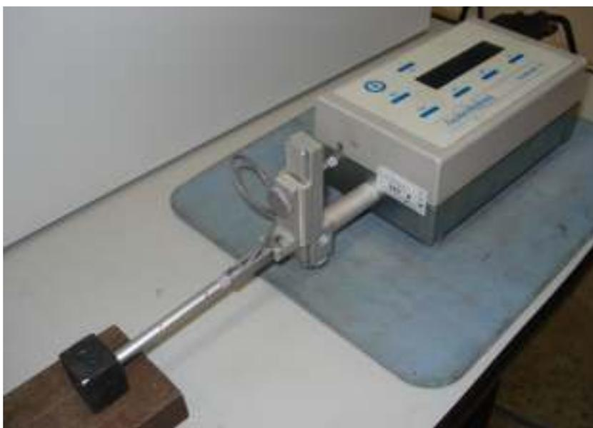
Figura 48: Medição de rugosidade na periferia do furo da amostra usinada no regime de desbaste.
