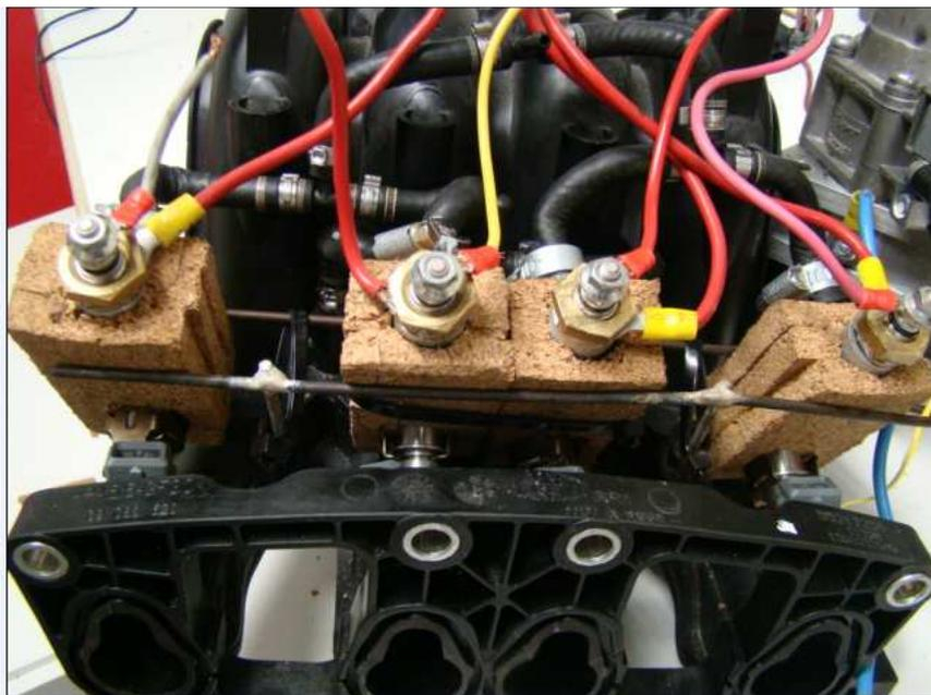
Figura 41: Isolamento térmico com cortiça dos porta-eletrorinjetores para os testes em veículo.
