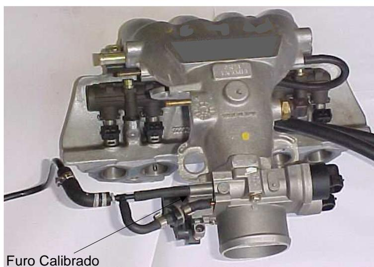
Figura 4: Sistema de partida a frio com introdução de gasolina por furo calibrado.
