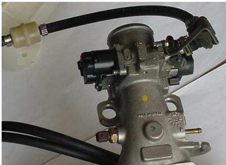
Figura 5: Sistema de partida a frio com introdução de gasolina por um eletro injetor.
