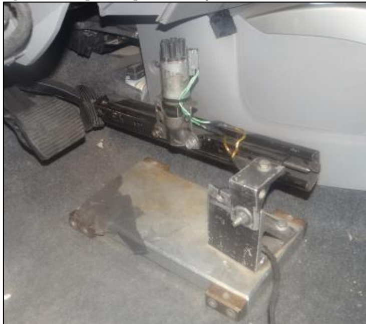
Figura 15 - Dispositivo para aceleração do veículo durante o teste
