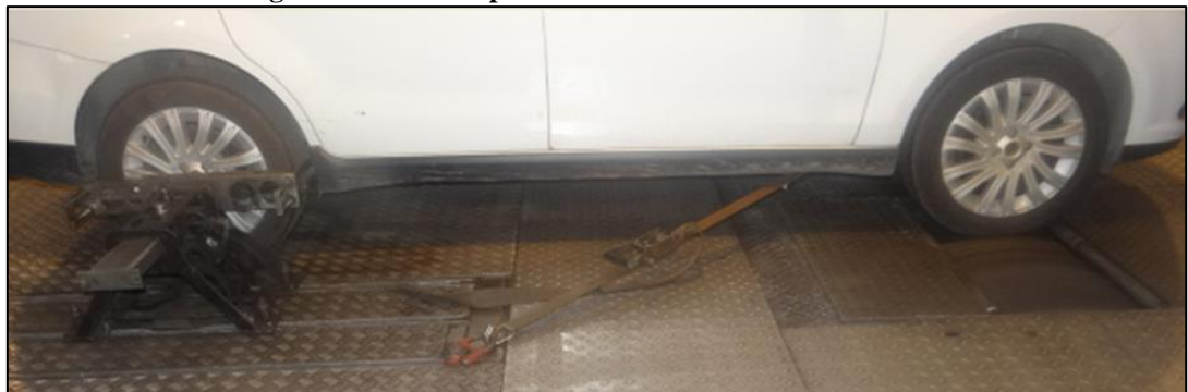
Figura 12 - Veículo preso no rolo dinamométrico
