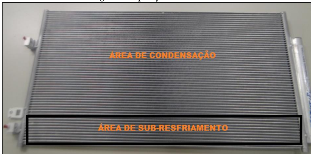
Figura 8 - Separação de áreas do condensador
