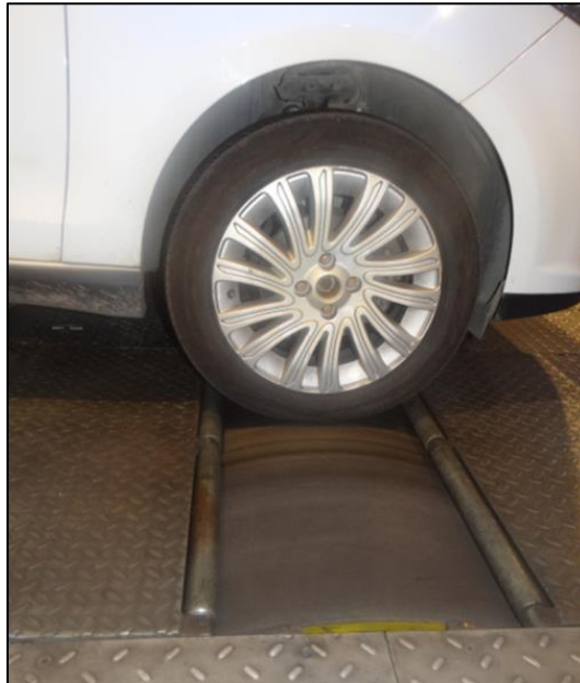
Figura 14 - Roda dianteira sobre o rolo dinâmométrico
