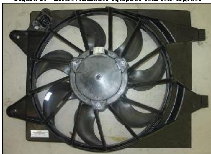
Figura 10 - Eletroventilador equipado com convergedor
