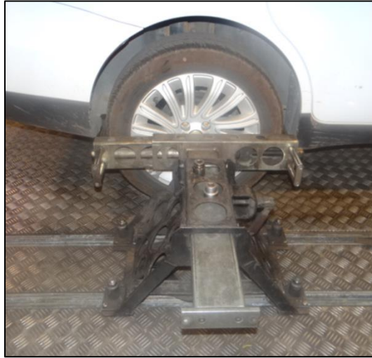
Figura 13 - Roda traseira fixada ao suporte
