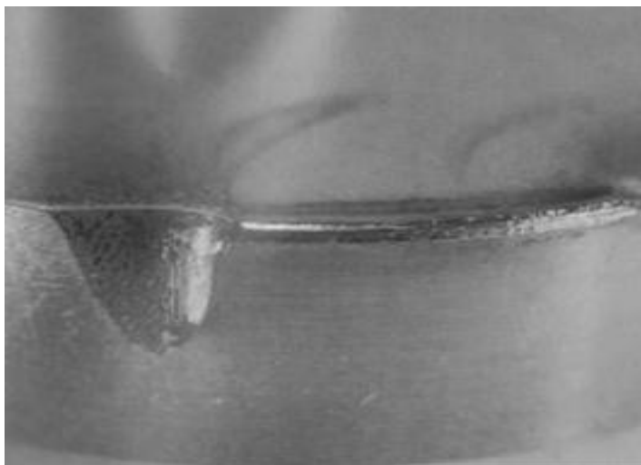
Figura 7 - Desgaste de entalhe na superfície de saída de uma ferramenta (INTRODUÇÃO AOS PROCESSOS DE USINAGEM 2010).
