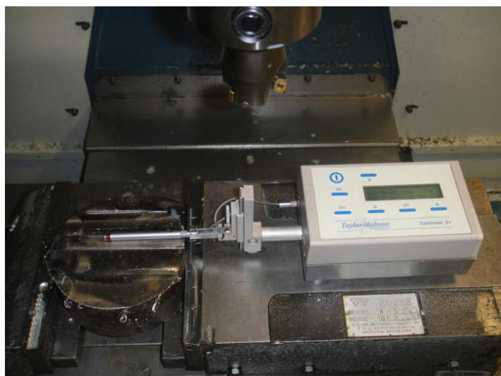
Figura 26 - Rugosímetro Taylor Hobson – Surtronic 3+ em funcionamento, evidenciando a medição da rugosidade.
