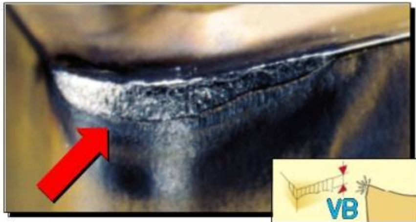
Figura 12 - Mecanismo de abrasão na ferramenta de corte (ISCAR, 2001).
