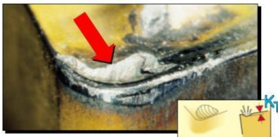
Figura 11 - Mecanismo de difusão ocorrido na superfície de saída da ferramenta (ISCAR, 2001)
