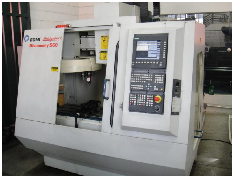
Figura 22 - Centro de usinagem Discovery 560, utilizado no fresamento do aço ABNT4140 temperado/revenido.
