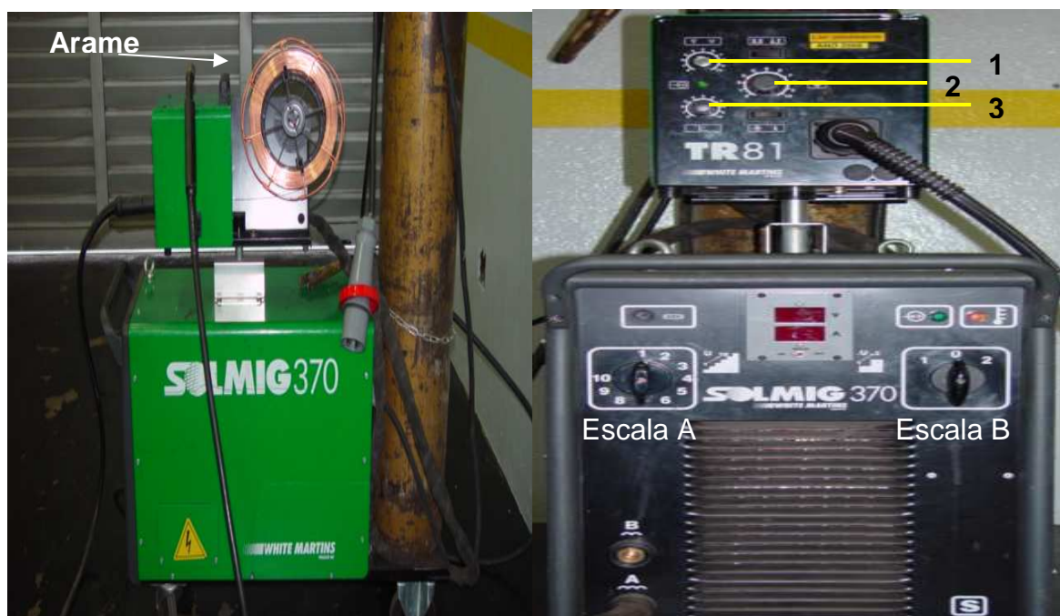
Figura 10: Máquina de soldagem GMAW, onde se evidencia a fonte e o arame como material de adição da solda
