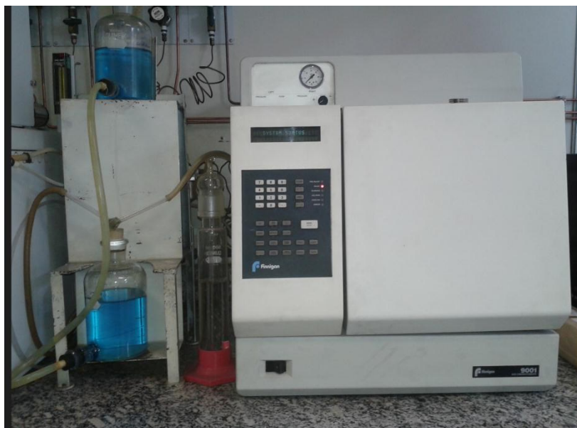
Figura 44 Cromatógrafo Finnigan 9001 utilizado para análise de amostras de gás do forno contínuo
