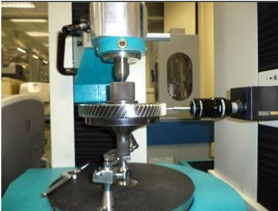
Figura 61 Máquina utilizada para controle de engrenagens e eixos
