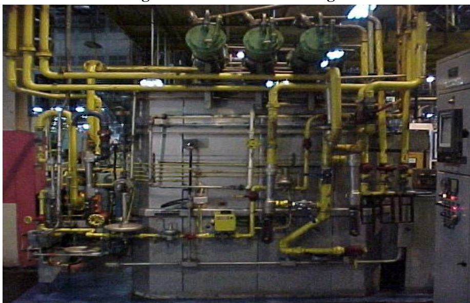
Figura 49 Gerador de Endogás
