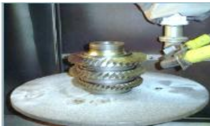
Figura 63 Posicionamento das coroas no “ shot peening ”
