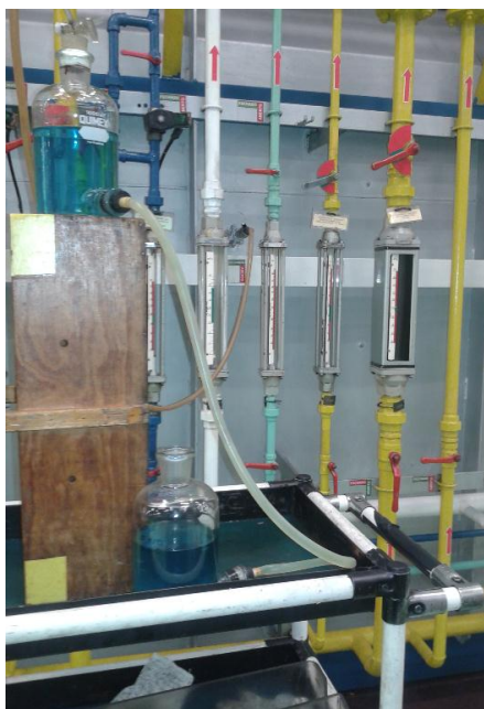
Figura 46 Conjunto sendo utilizado para coleta de gás no forno contínuo onde vai ser utilizado
