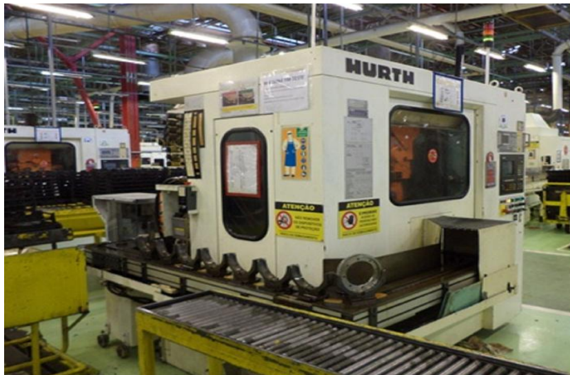
Figura 55 Raspadora para ajuste do perfil de evolvente.
