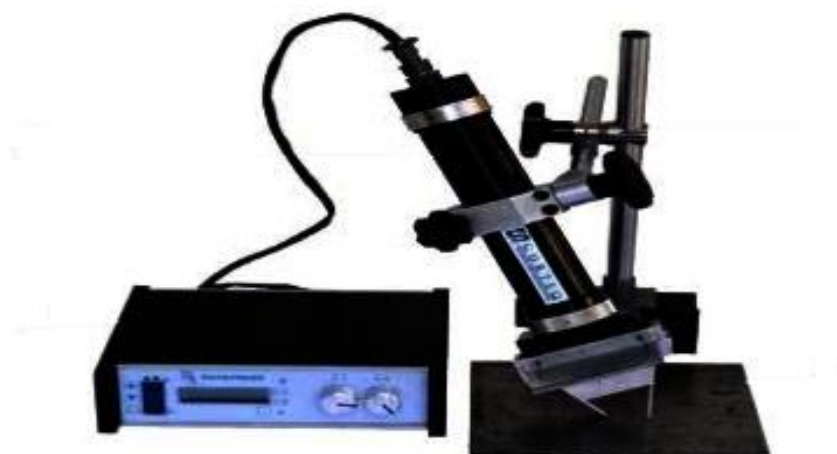
Figura 66 Equipamento portátil de raios-X para medição de tensões mecânicas
