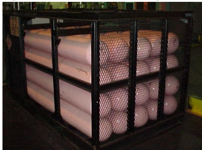
Figura 48 Bateria com cilindros de gás natural
