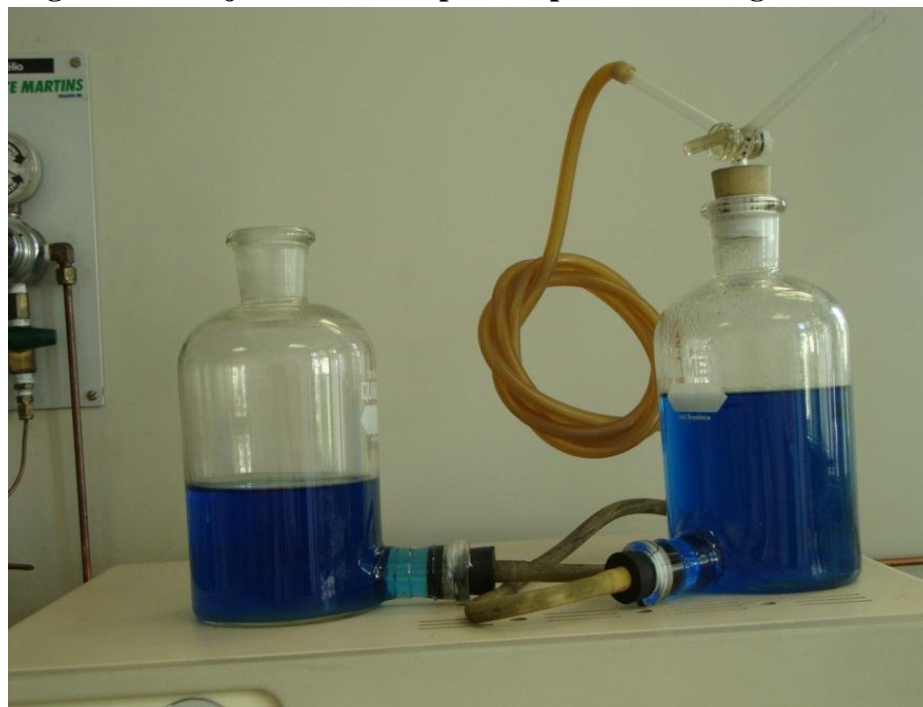
Figura 45 Conjunto de baixa pressão para coleta de gás no forno
