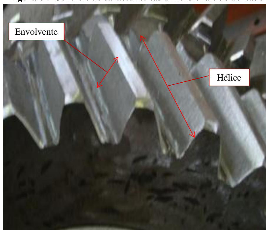
Figura 62 Controle de características dimensionais do dentado
