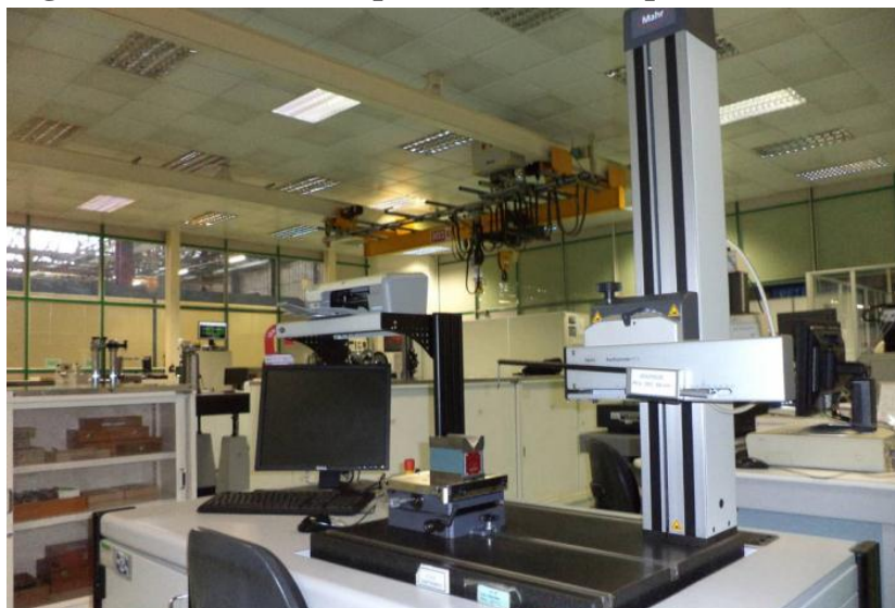
Figura 65 Perfilômetro para medida da espessura corroída.
