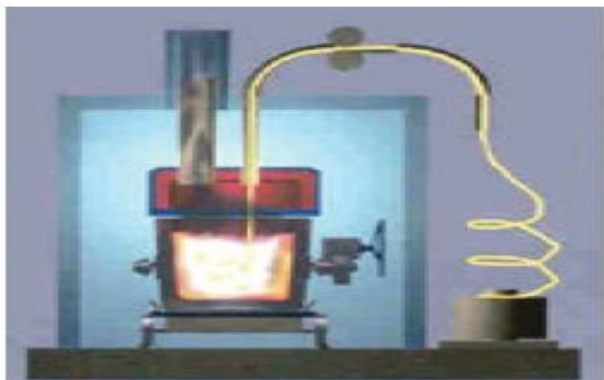
Figura 19 - Exemplo processo de nodularização por “arame recheado”.
