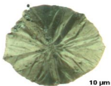
Figura 16 – Imagem tridimensional obtida em microscópio óptico, mostrando o crescimento radial da grafita.
