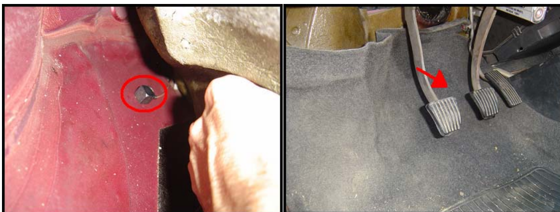
Figura 4.22 – Acelerômetro instalado no piso do veículo próximo ao pedal de freio. Fonte: Próprio trabalho.
