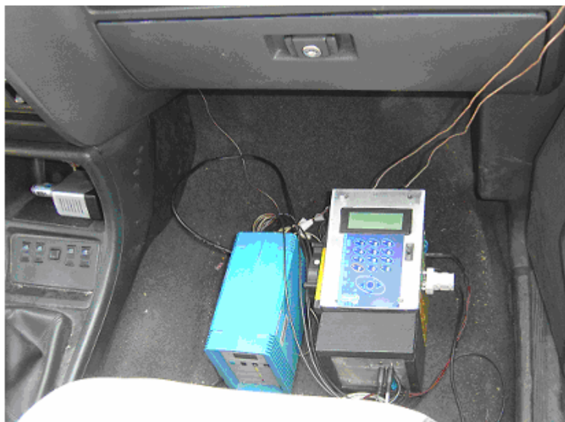
Figura 4.25 – Sistema de aquisição de dados e condicionador de sinais dos acelerômetros. Fonte: Próprio trabalho.
