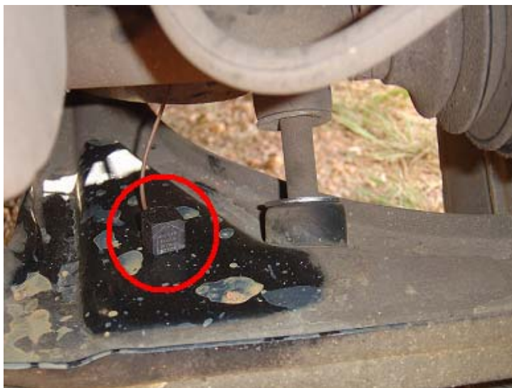
Figura 4.20 – Acelerômetro instalado no leque da suspensão. Fonte: Próprio trabalho.
