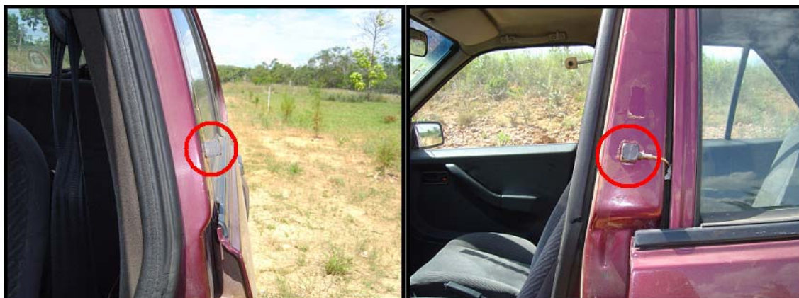
Figura 4.21 – Acelerômetro instalado na coluna do veículo no lado do condutor. Fonte: Próprio trabalho.
