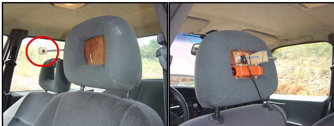
Figura 4.23 – Microfone à esquerda e circuito pré-amplificador à direita instalado no encosto de cabeça do condutor.
