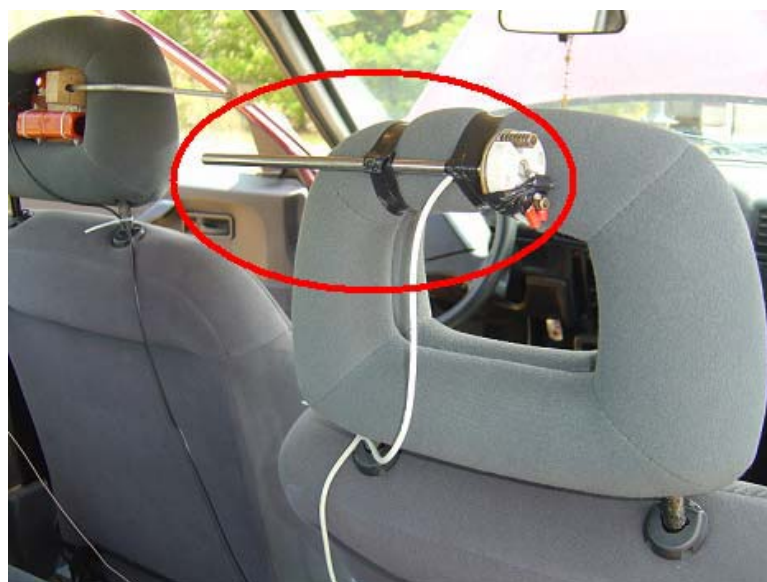
Figura 4.24 – Sensor de temperatura tipo PT-100 instalado no encosto de cabeça do passageiro.
