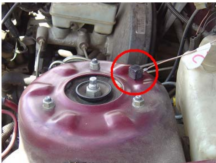
Figura 4.19 – Acelerômetro instalado no ativo da suspensão. Fonte: Próprio trabalho.
