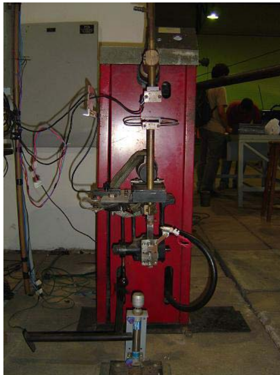
Figura 3.2 – Máquina de solda a ponto utilizada no desenvolvimento do equipamento para simulação do processo de indução para a obtenção dos dados referentes à ZTA e de rebarba (Santana, 2002).
