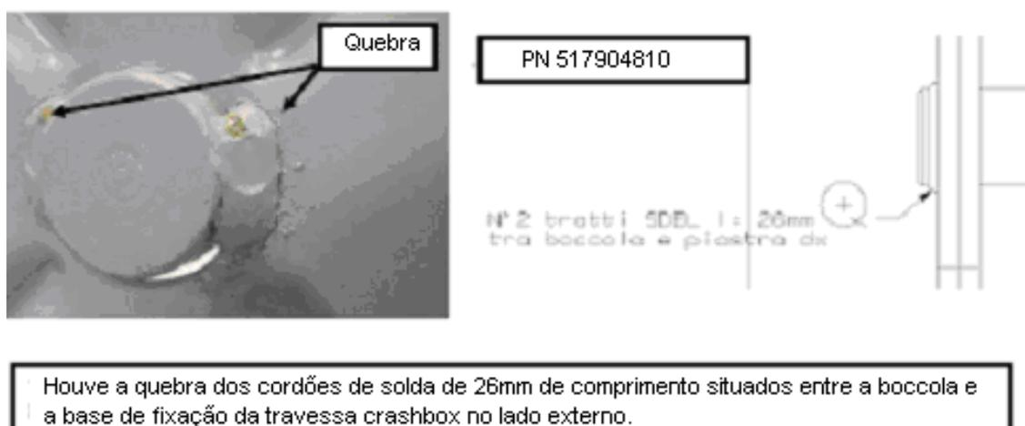
Figura 4.6 Quebra da solda entre bucha e a base de fixação do lado externo.
