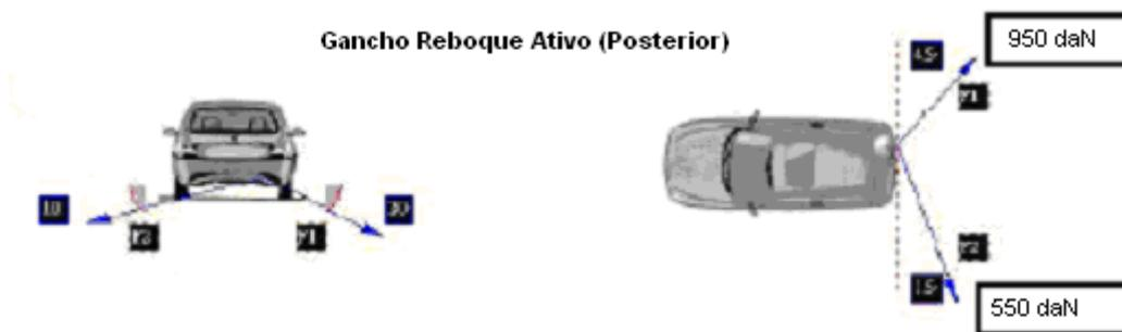
**Figura 4.15: Esquema de aplicação de carga para a prova dinâmica**
