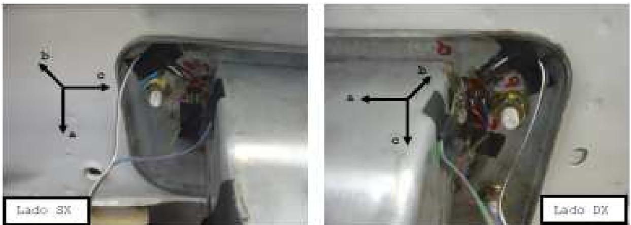
Figura 3.15: Posicionamento das rosetas em ambos os lados da crashbox
