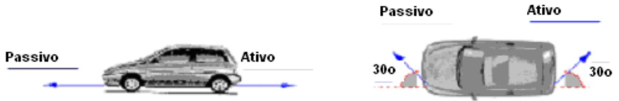
Figura 3.14: Aplicação de carga na prova de rigidez estática
