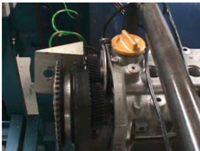
Figura 2 – Cabeçote com alterações e a roda dentada instalada após o par de engrenagens e a polia da correia dentada.
