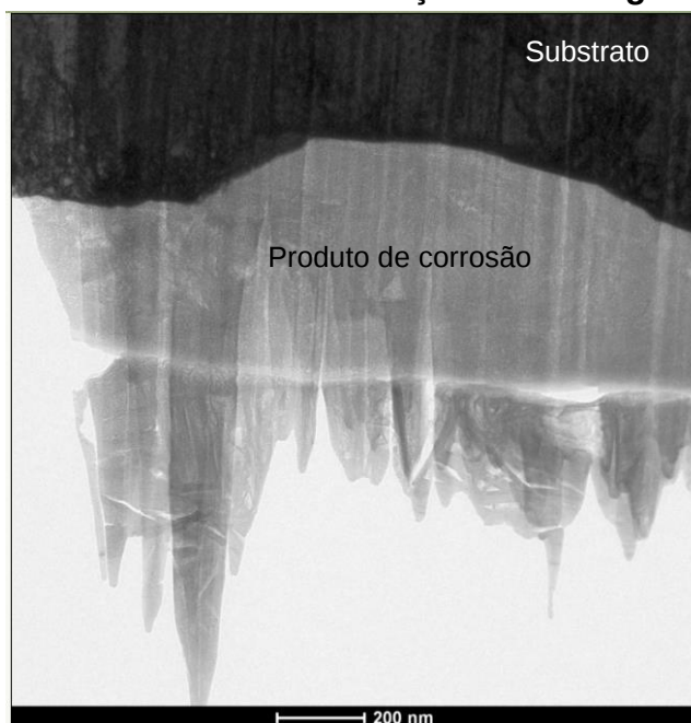
Figura 41 – Imagem de campo claro do ponto 1, da Figura 40, no substrato de aço ASTM A36 na direção cristalográfica [001]. Pontos e regiões mais escuros indicam estarem na família de direções cristalográficas <001>
