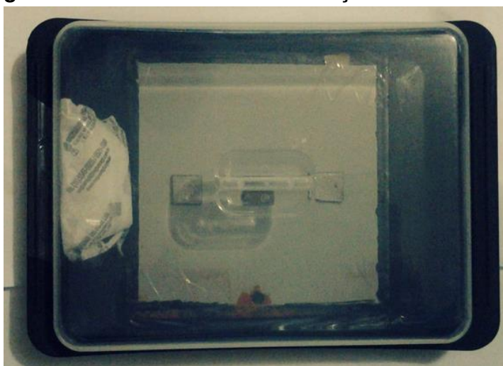
Figura 13 – Placa com três corpos de prova, acondicionados em caixa plástica, antes de sofrerem corrosão, fixados por fita dupla face adesiva. Pacote de sílica gel foi colocado contra a absorção de umidade
