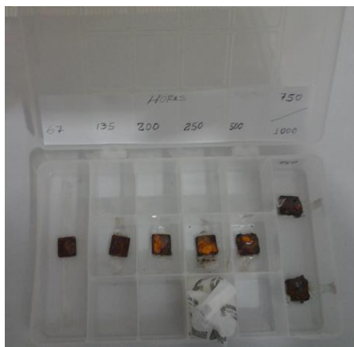
Figura 17 – Embalagem plástica com corpos de prova, após sofrerem corrosão acelerada em vários intervalos de tempo
