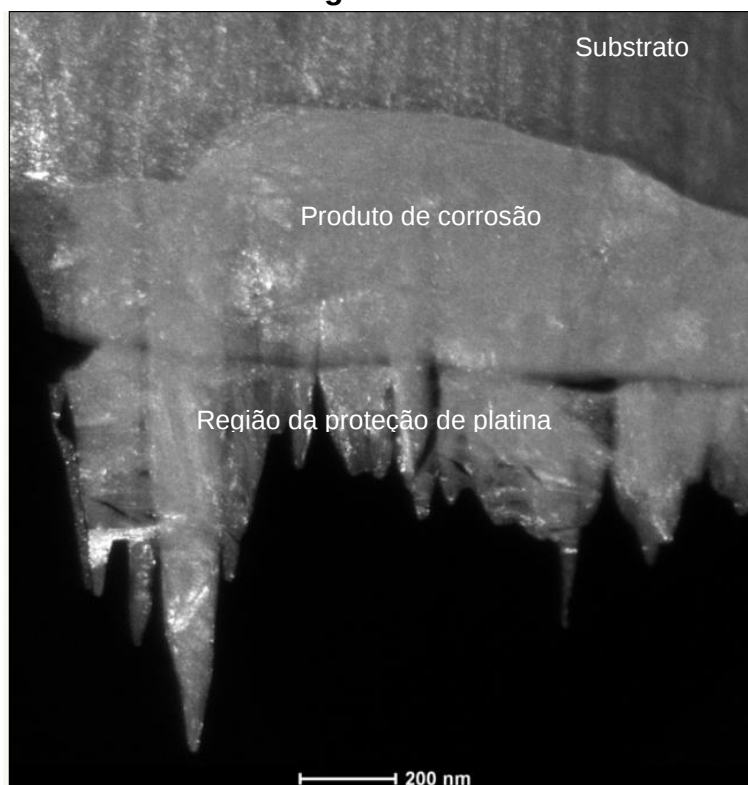
Figura 39 – Imagem de campo escuro na região do produto de corrosão, na direção cristalográfica [440] , referente ao anél externo do SADP da Figura 38. Pontos e regiões mais claros indicam estarem na família de direções cristalográficas \langle 440 \rangle
