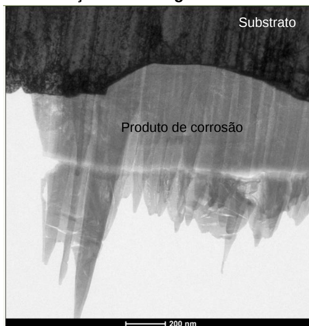
Figura 45 – Imagem de campo claro no substrato de aço ASTM A36 na direção cristalográfica [10\bar{1}] . Pontos e regiões mais escuros indicam estarem na família de direções cristalográficas <101>
