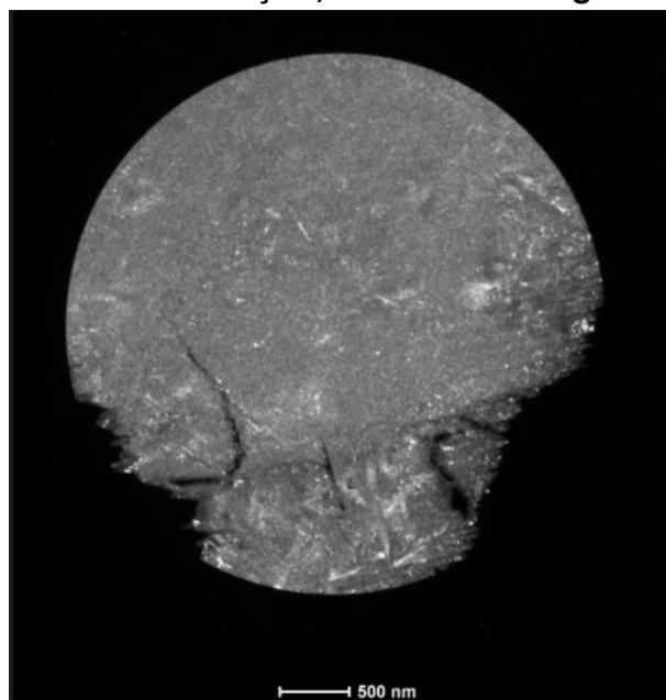
Figura 72 – Imagem de campo escuro na região do produto de corrosão, na direção da família de planos cristalográficos \langle 440 \rangle , referente ao anel mais externo de difração, indicado na Figura 71
