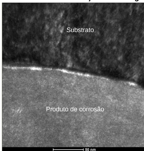
Figura 48 – Imagem de campo escuro do ponto 3, da Figura 40, no substrato de aço ASTM A36 na direção cristalográfica [\bar{1}\bar{1}0] . Pontos e regiões mais claros indicam estarem na família de direções cristalográficas \langle \bar{1}\bar{1}0 \rangle
