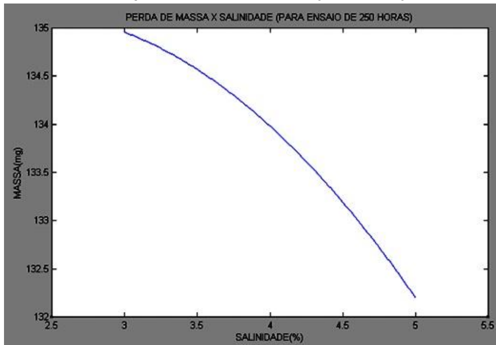
Figura 7 – Gráfico de perda de massa em relação à variação de salinidade
