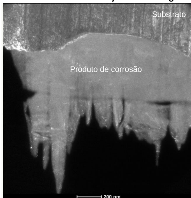
Figura 42 – Imagem de campo escuro do ponto 2, da Figura 40, no substrato de aço ASTM A36 na direção cristalográfica [1\bar{1}0] . Pontos e regiões mais claros indicam estarem na família de direções cristalográficas \langle 1\bar{1}0 \rangle
