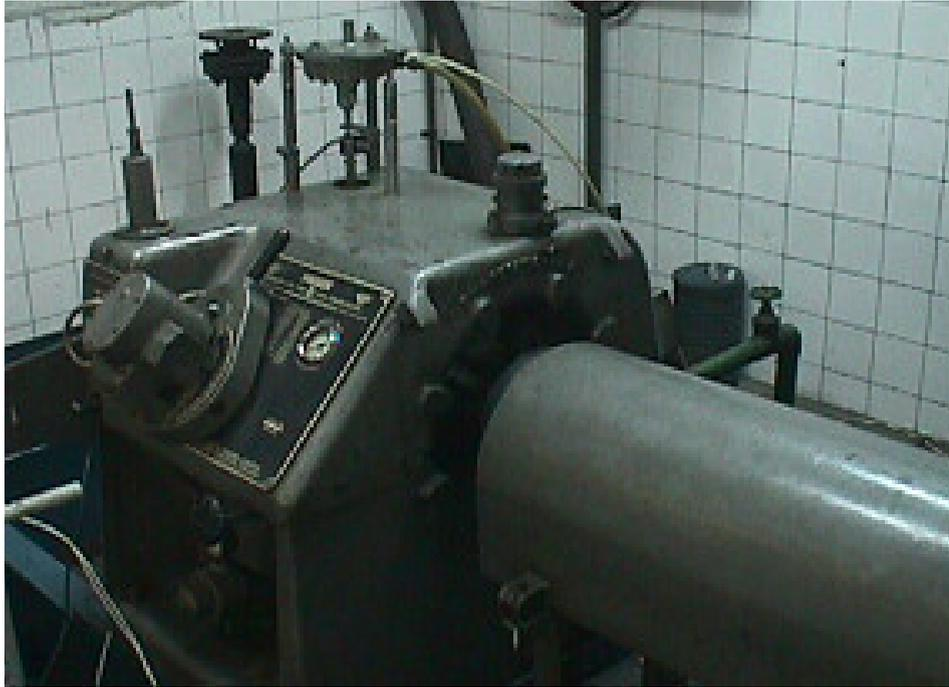
Figura 3.12 - Dinamômetro utilizado no experimento
