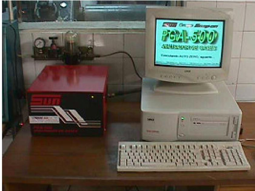
Figura 3.18 - Analisador de gases utilizado no experimento
