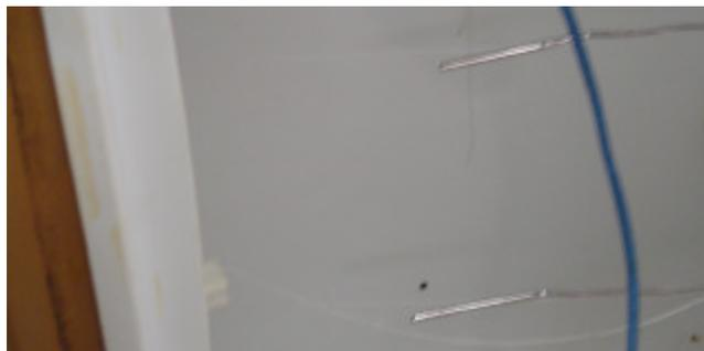
Figura 3.3 - Detalhe da fixação dos sensores de temperatura no interior do refrigerador
