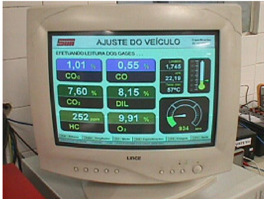
Figura 3.20 - Tela do supervisor do analisador de gases
