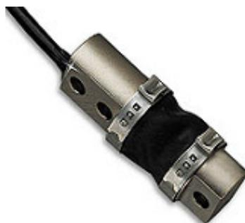
Figura 3.13 - Célula de carga utilizada no experimento
