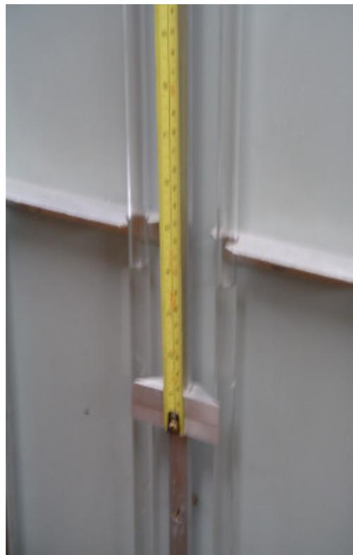
Figura 3.7 - Manômetro de coluna d'água utilizado para medição da pressão do GLP consumido pelo sistema de combustão do refrigerador
