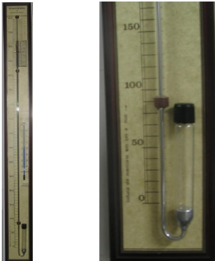
Figura 3.9 - Barômetro com termômetro de bulbo utilizados nos experimentos
