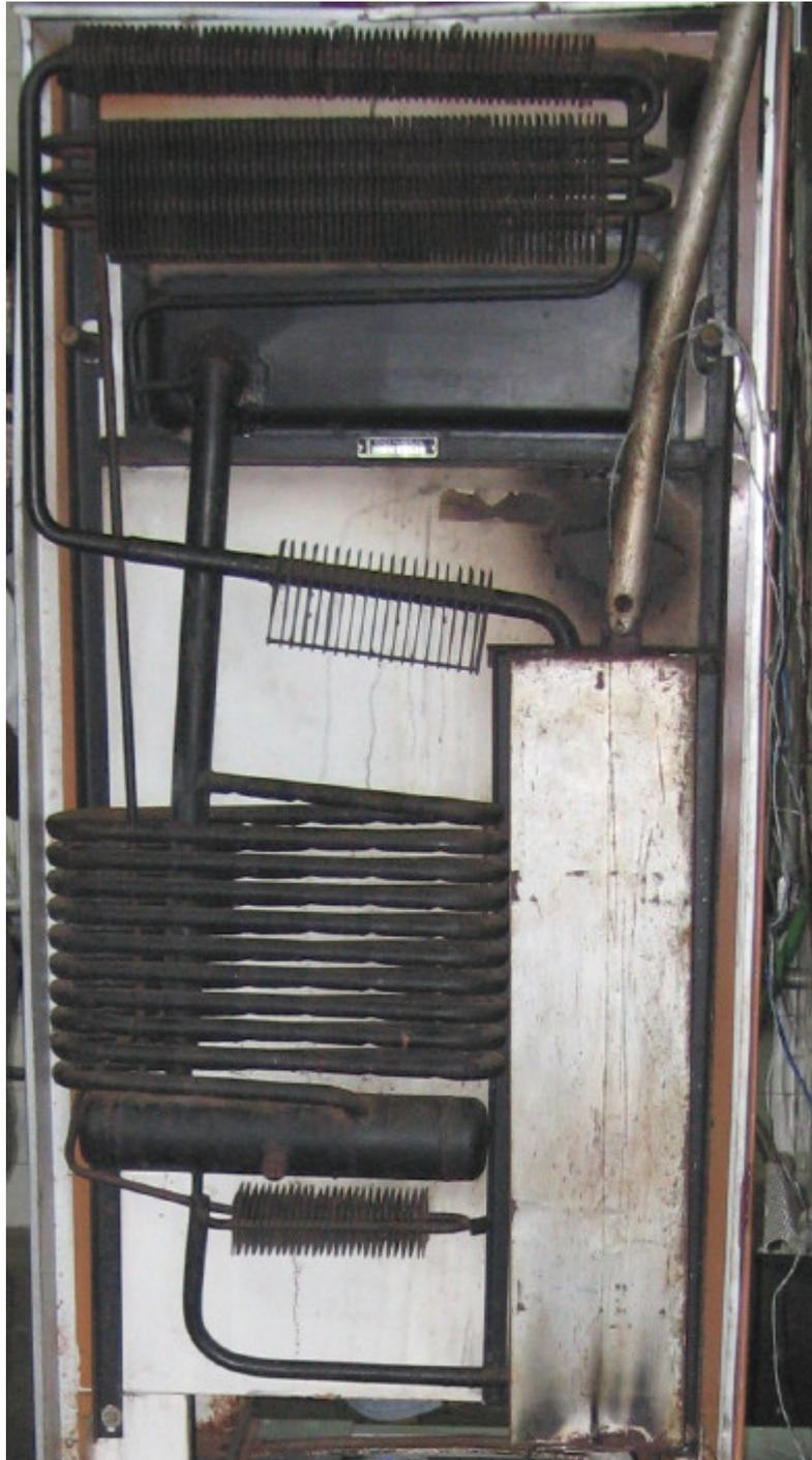
Figura 3.1 - Sistema de refrigeração por absorção utilizado no experimento
