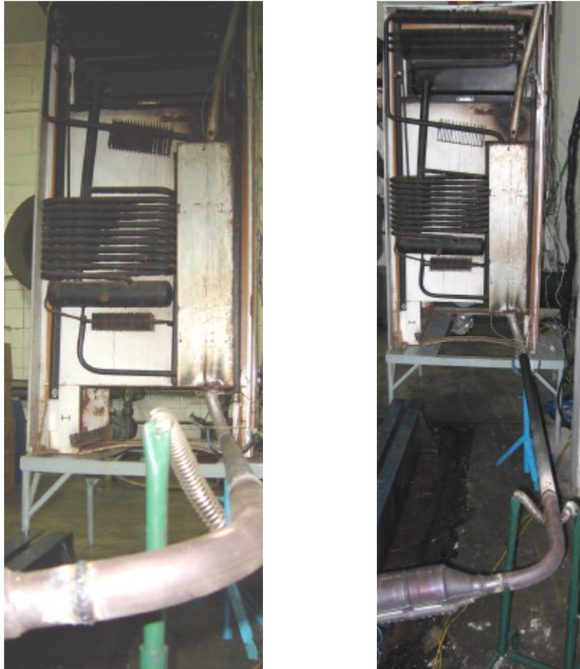
Figura 3.2 - Sistema de refrigeração por absorção adaptado ao sistema de exaustão do motor de combustão interna
