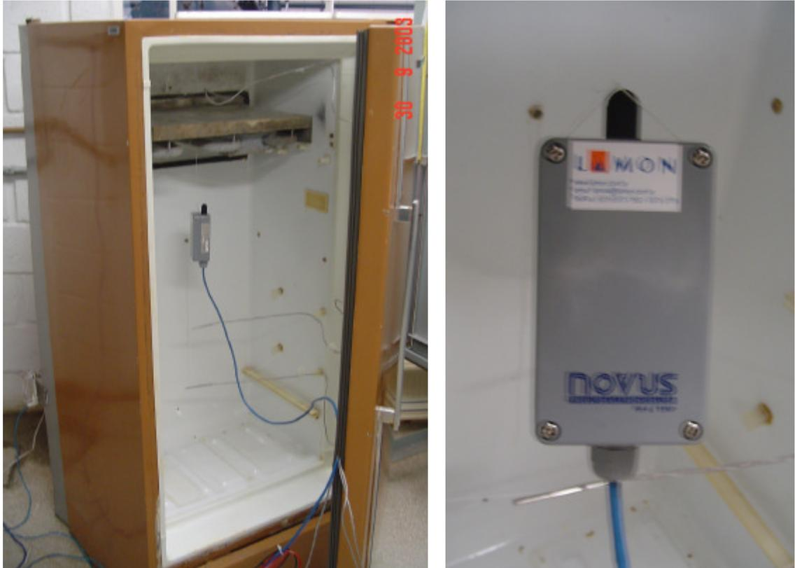
Figura 3.4 - Sensor de temperatura / umidade
