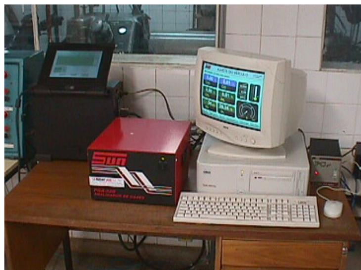
Figura 3.19 - Analisador de gases e computador com software de operação
