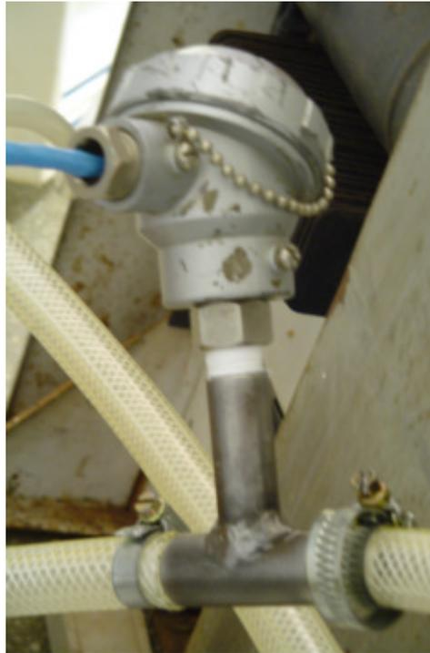
Figura 3.6 - Termopar tipo T utilizado para medição da temperatura do GLP consumido pelo sistema de combustão do refrigerador
