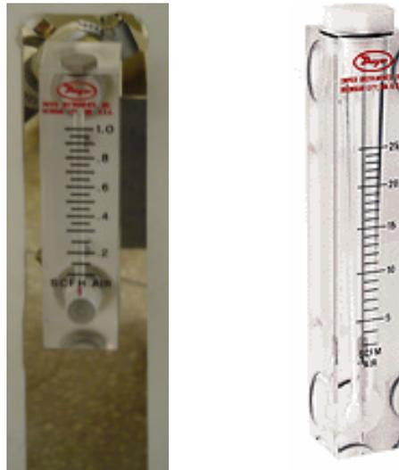
Figura 3.8 - Rotâmetro utilizado para medição da vazão volumétrica do GLP consumido pelo sistema de combustão do refrigerador
