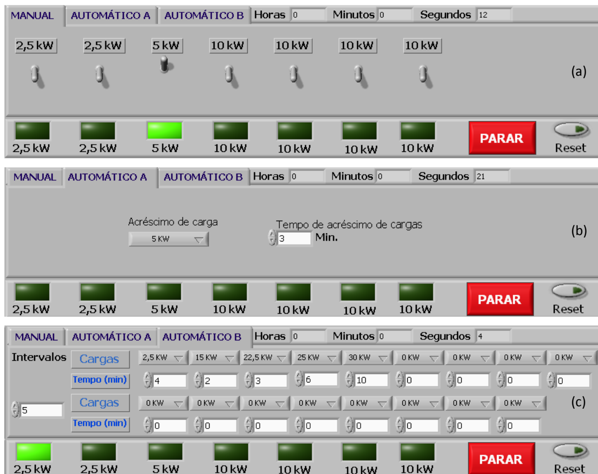
Figura 31 – Interfaces dos programas MANUAL (a), AUTOMÁTICO A (b) e AUTOMÁTICO B (c).
