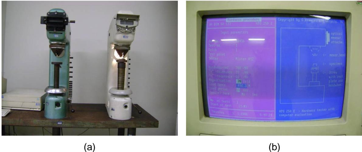
**Figura 19: Durômetro Vickers:**
