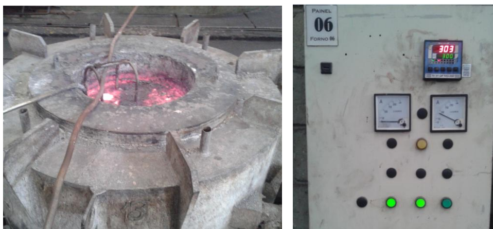
Figura 20 – Forno elétrico com banho de sal – austenitização
