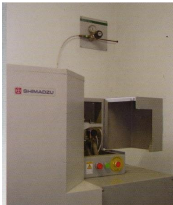
Figura 18 – Espectrômetro de emissão ótica
