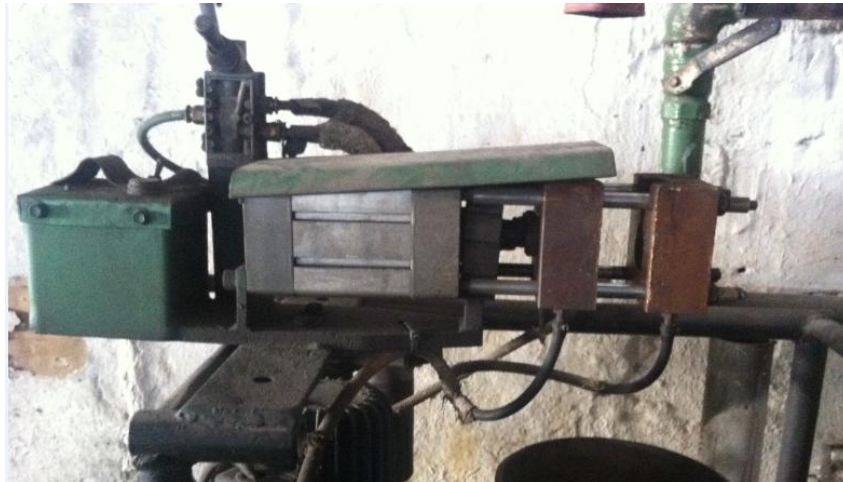
Figura 17 – Coquilha refrigerada em cobre para obtenção de pastilha para análise espectrométrica
