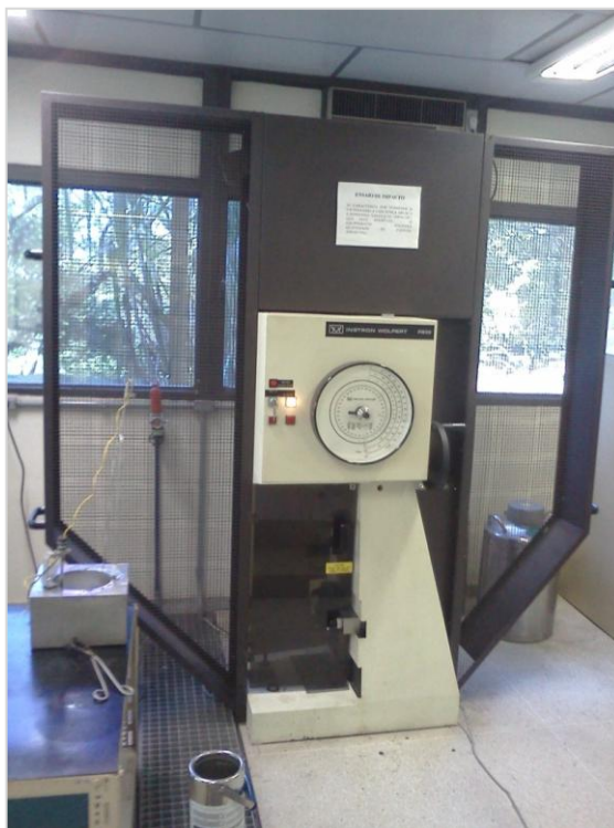
Figura 25 – Máquina de ensaio Charpy, marca Instron Wolpert PW30
