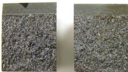
Figura 36 – Superfície de fratura de corpo de prova após ensaio Charpy
