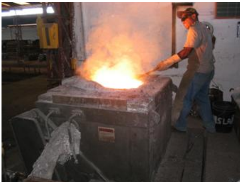
Figura 16 – Forno elétrico à indução Inductotherm 1.0 t
