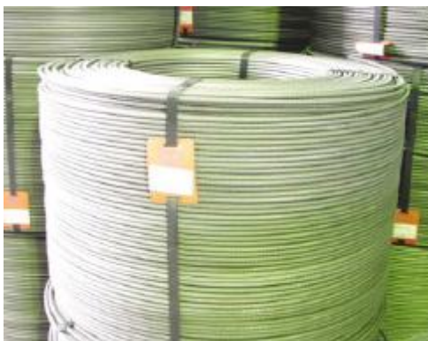
Figura 21 - Fio máquina estocado depois da inspeção.
