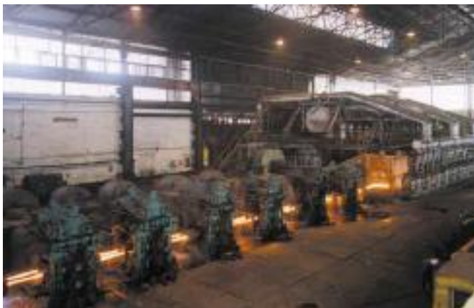
Figura 19 - Laminação do produto do lingotamento.
