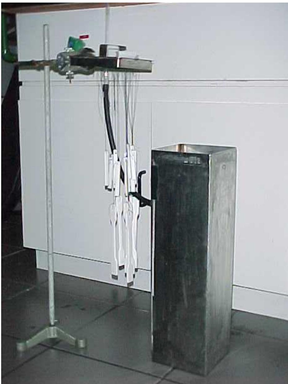
Figura 3.1 – Esquema representativo do reservatório metálico, construído na Fiat, onde foram imersos os corpos-de-prova nos diferentes combustíveis.
