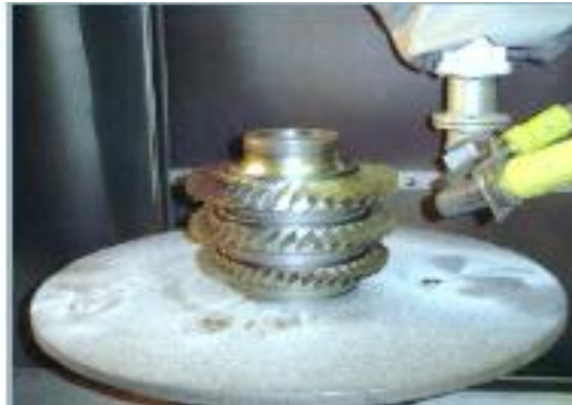
Figura 56 Posicionamento das coroas no “ shot peening ”
