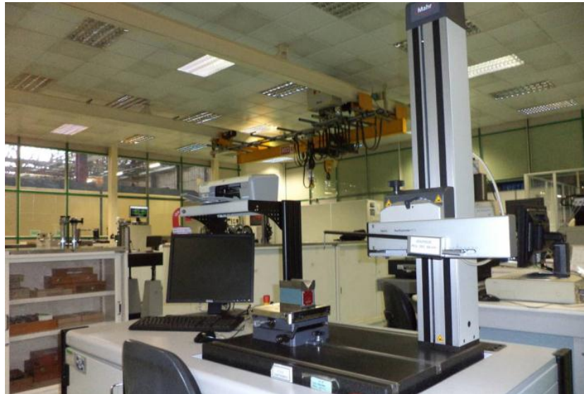
Figura 58 Perfilômetro para medida da espessura corroída.
