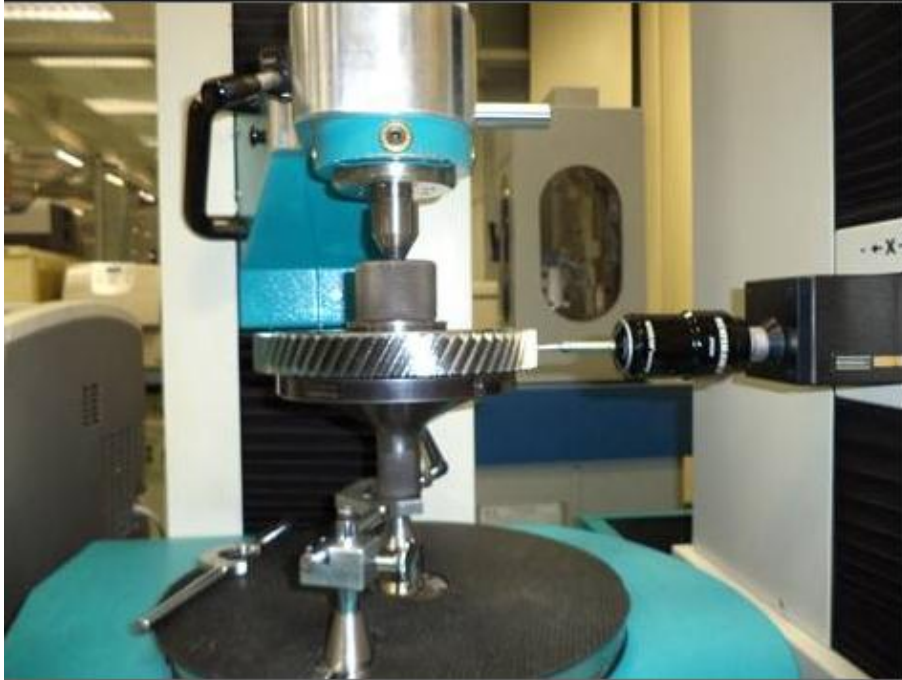
Figura 53 Máquina utilizada para controle de engrenagens e eixos
