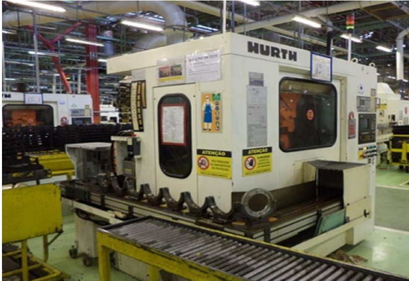
Figura 47 Raspadora para ajuste do perfil de evolvente.
