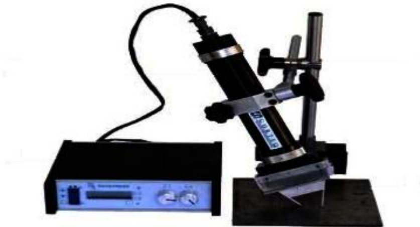
Figura 59 Equipamento portátil de raios-X para medição de tensões mecânicas
