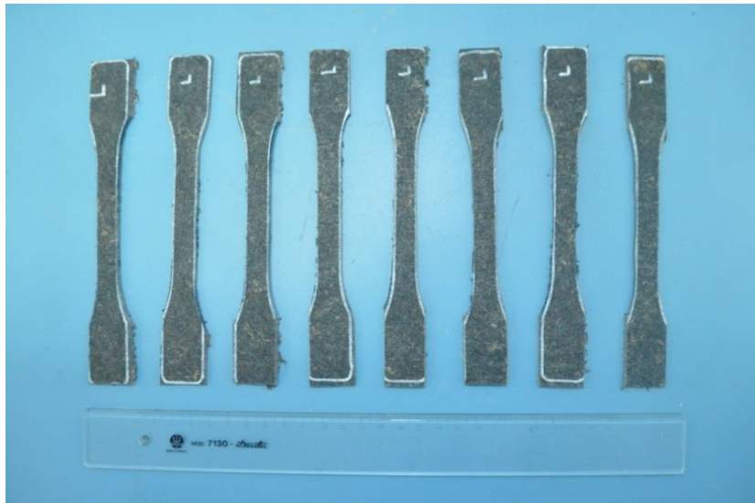
Figura 77 – Corpos de prova para tração em fibra de juta com polipropileno.
