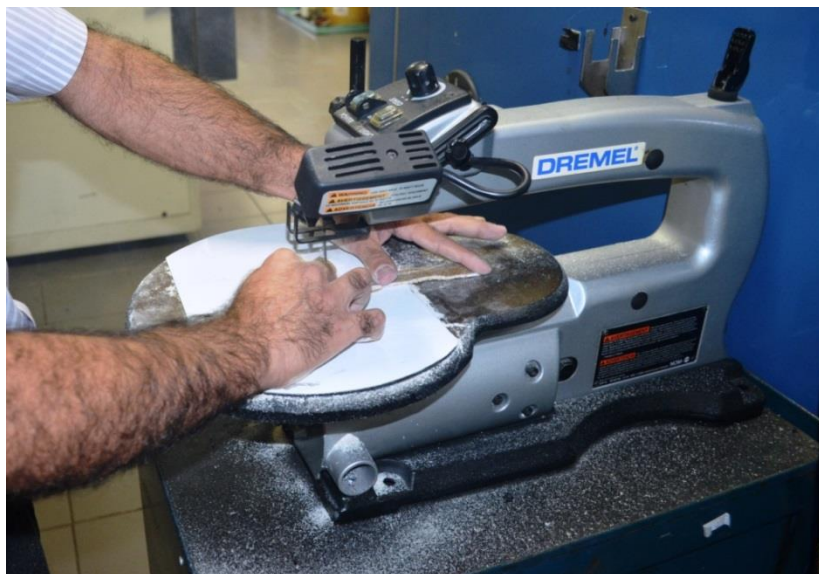
Figura 76 – Corpos de prova sendo cortados em uma máquina de serra fita Dremel.
