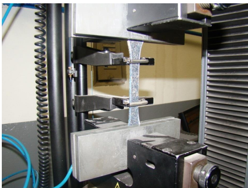
Figura 88 – Ensaio de tração em corpos de prova a 23°C.
