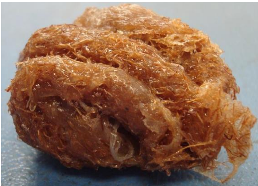
Figura 60 – Corpos de prova com 30,0% de sisal e 70,0% de resina renovável.
