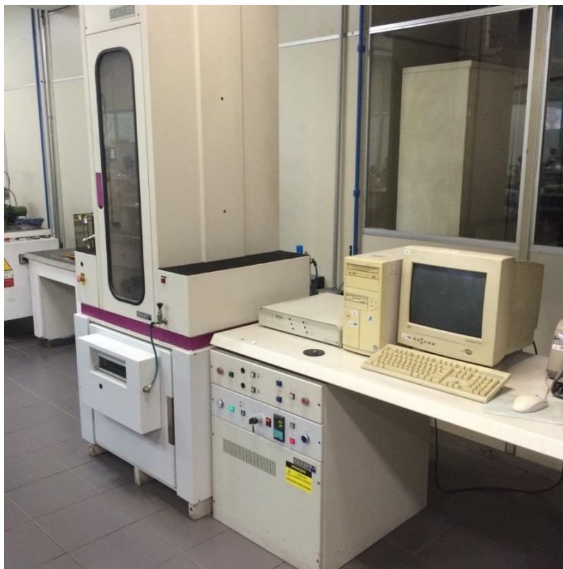
Figura 91 – Equipamento CEAST para o teste de impacto por queda de dardo a 23°C.
