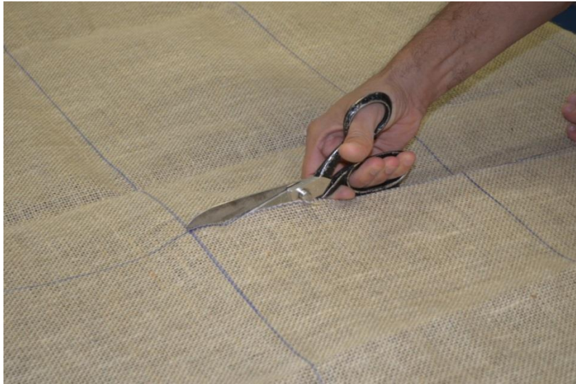
Figura 64 – Corte da Tela de juta 100,0% natural T10.
