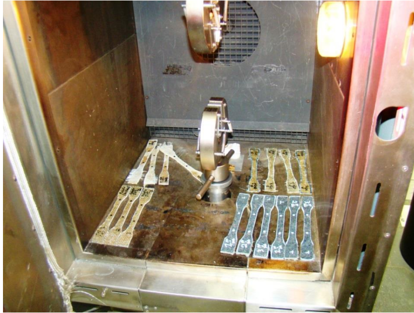
Figura 89 – Ensaio de tração em corpos de prova a 80°C.
