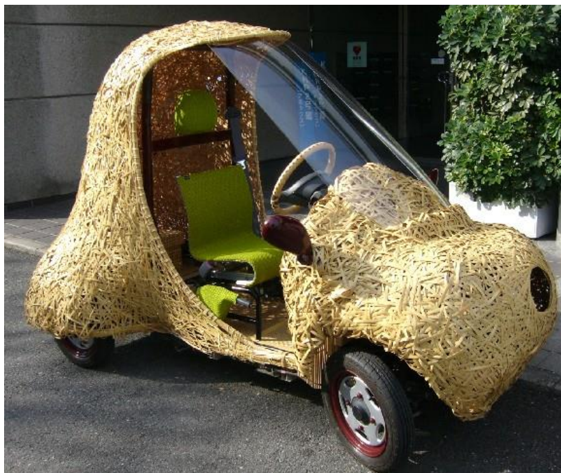
Figura 54 – Bamgoo car, carroceria feita em bambu.
