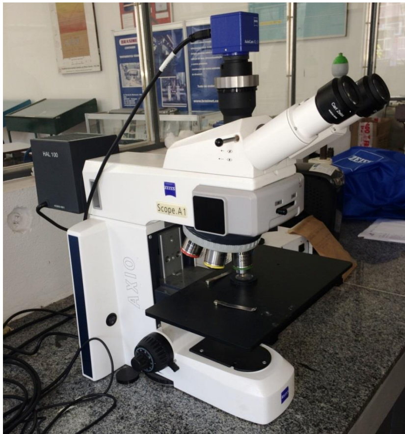
Figura 78 – Microscópio óptico Zeiss Scope A.1 modelo AX10.
