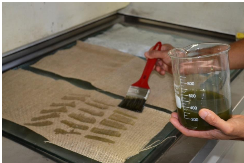
Figura 72 – Aplicação de resina epóxi misturada com o endurecedor na placa.
