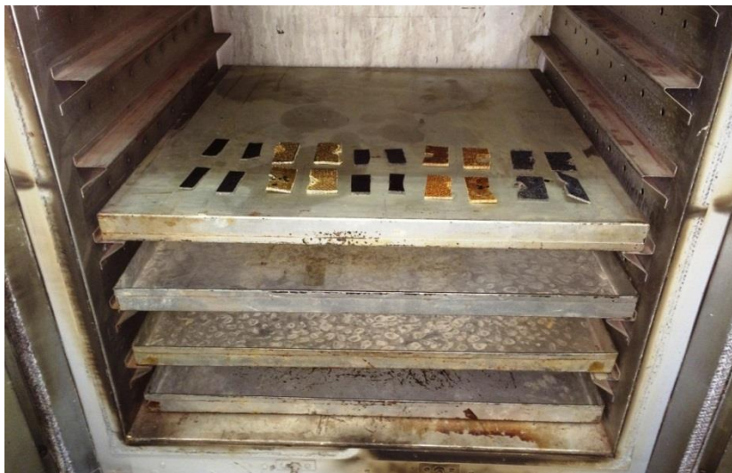
Figura 81 – Corpos de prova dentro do forno a 100°C.
