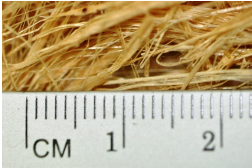
Figura 71 – Detalhe dos fios da fibra de banana.
