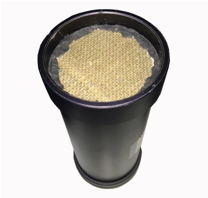
Figura 85 – Corpo de prova para baixas frequências inserido no tubo de impedância.
