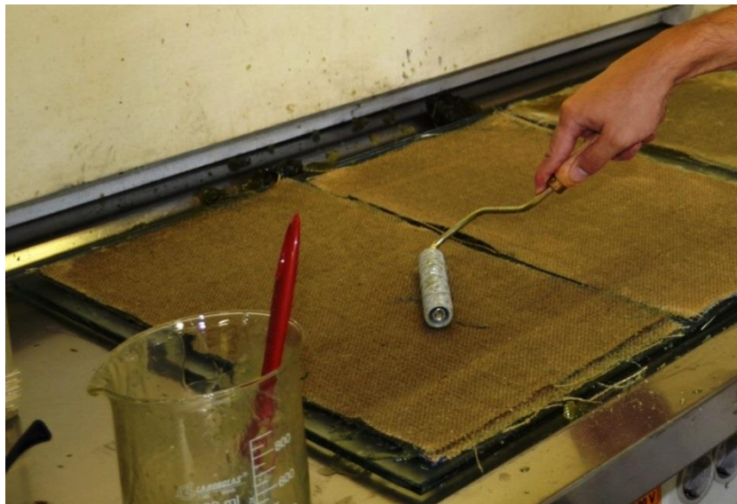
Figura 73 – Eliminação de bolhas de ar utilizando-se o rolete sobre o molde.
