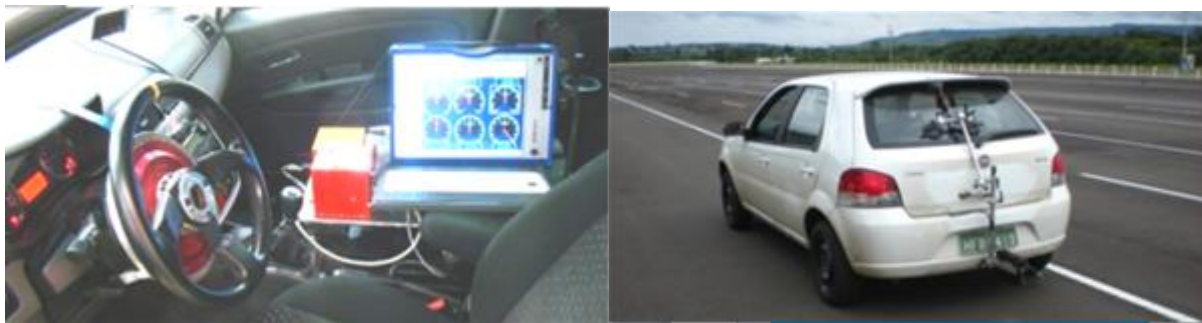
Figura 23 – exemplo de posicionamento da instrumentação no veículo
