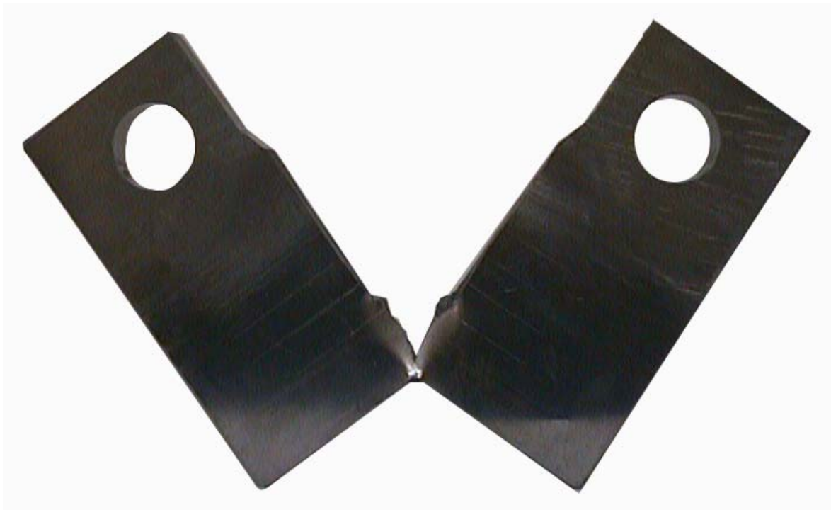
Figura 4.19 - Corpo-de-prova de espessura 19mm após ensaio de propagação de trinca por fadiga.
