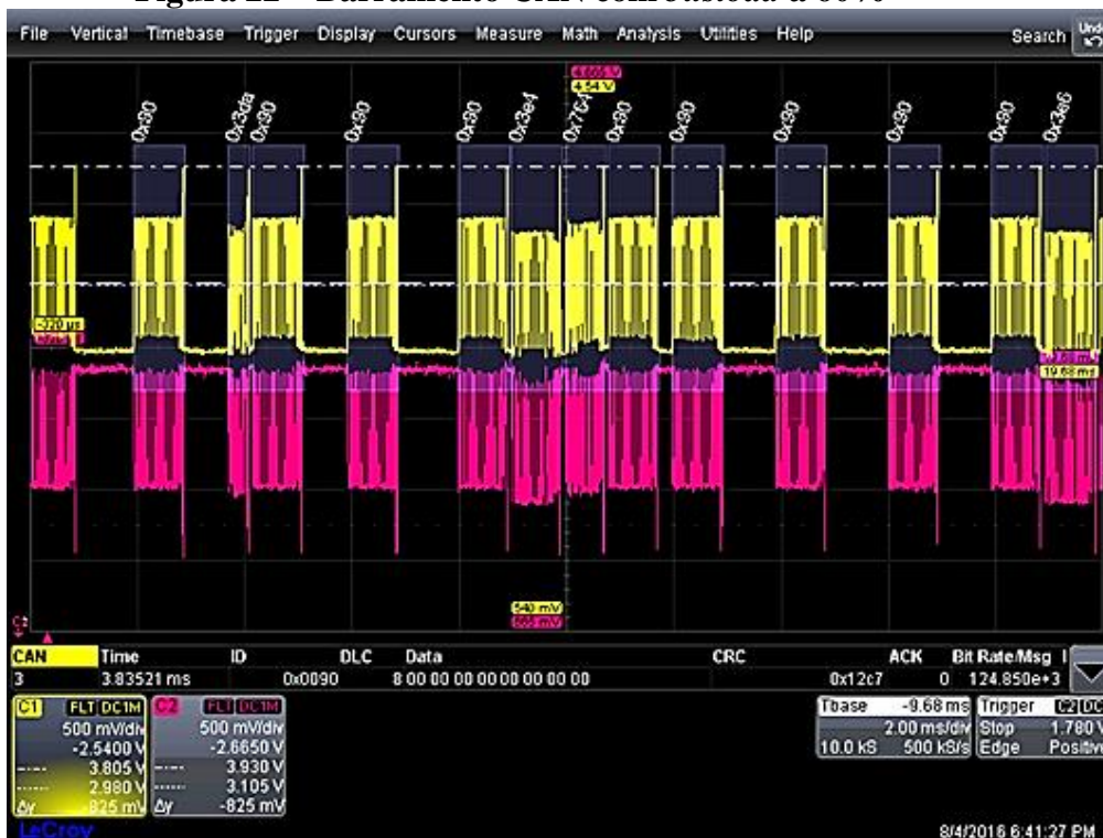
Figura 22 – Barramento CAN com busload a 60%
