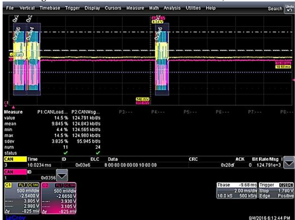
Figura 21 – Barramento CAN com busload a 14,5%
