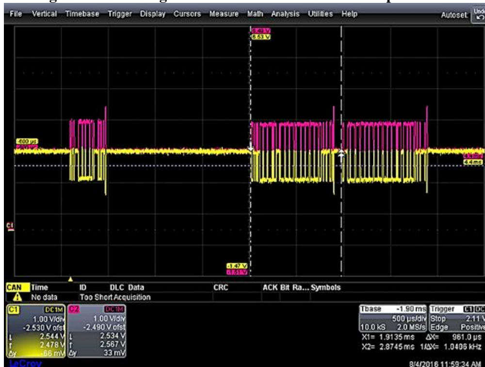
Figura 19 – Mensagem CAN observada em Osciloscópio normal
