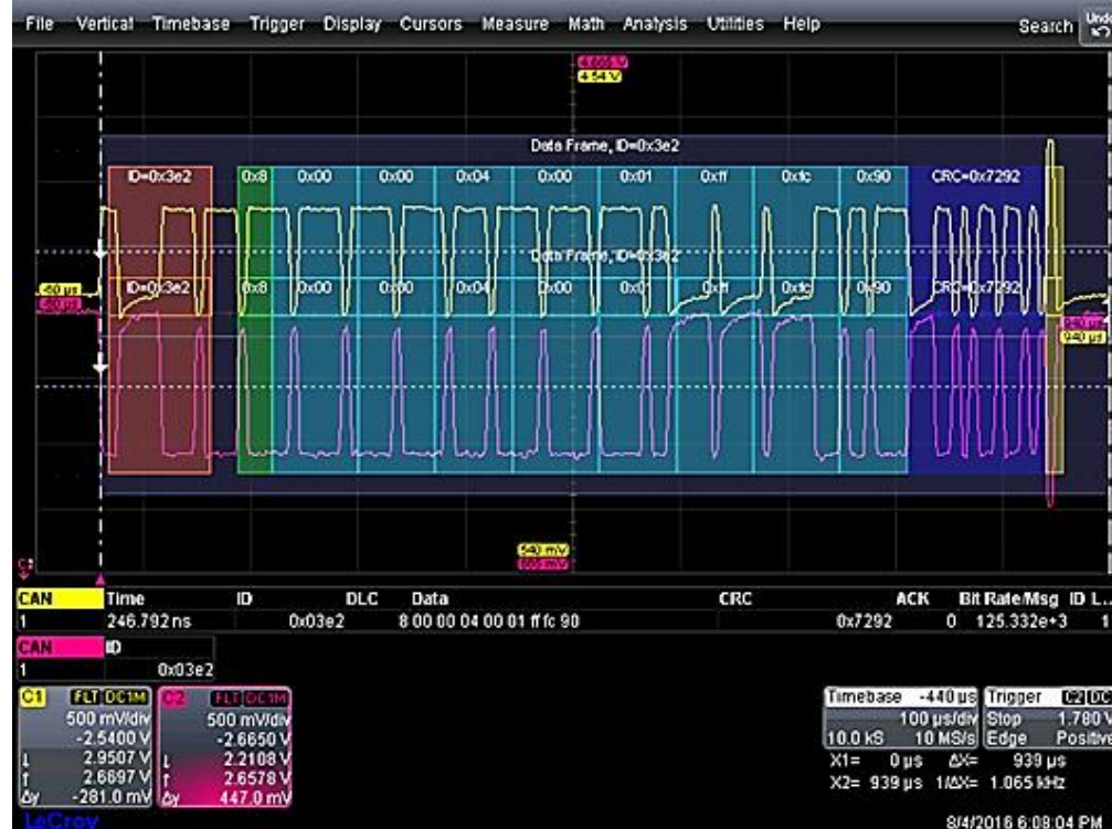
Figura 20 – Mensagem CAN em um Osciloscópio analisador de protocolo
