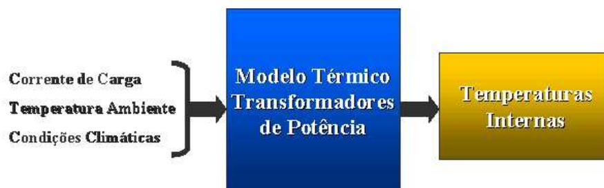
Figura 5.1: Esquema Básico de Modelo Térmico de Transformadores de Potência
