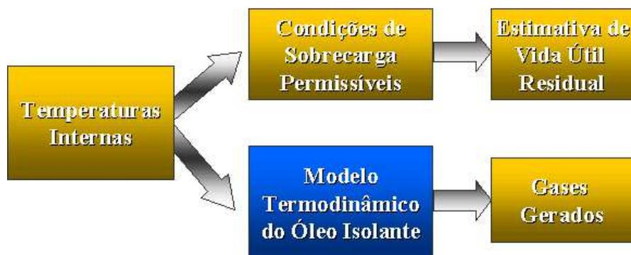
Figura 5.2: Esquema Básico de Modelo Térmico de Transformadores de Potência
