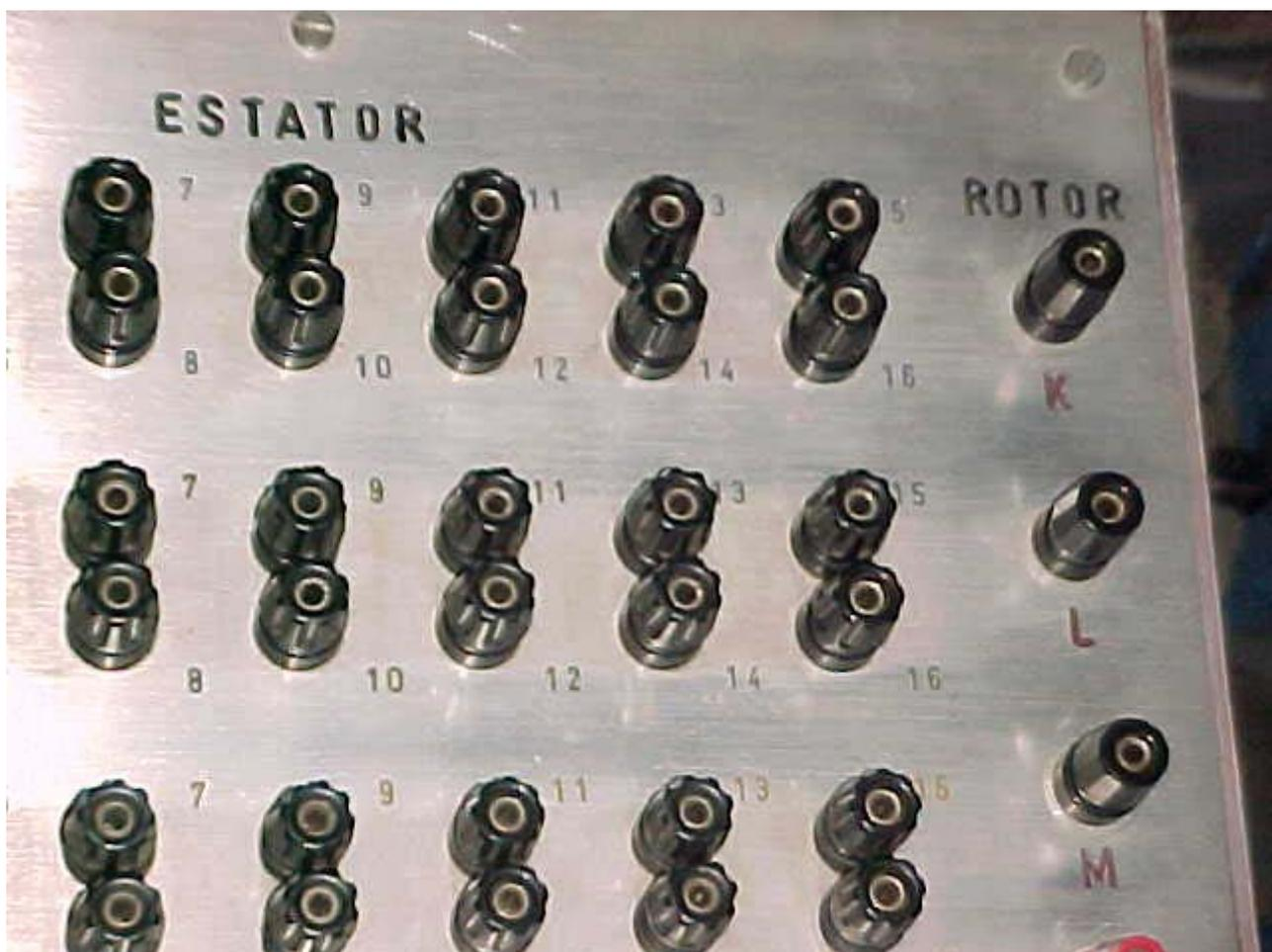
FIGURA 4 – Detalhe da Figura 3, mostrando terminais externos das bobinas 7-8 até 15-16 do estator e os terminais rotóricos.
