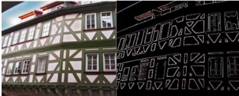
Figura 1 – Exemplo de detecção de bordas por Canny
