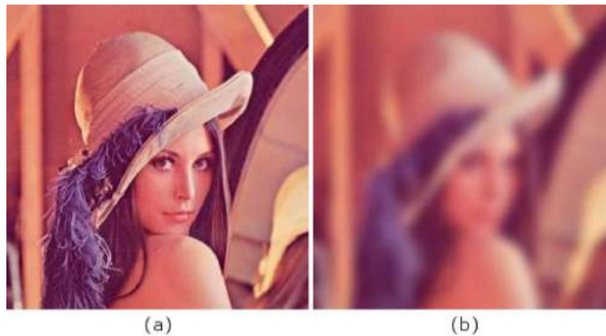
Figura 1 – (a) Imagem original; (b) Exemplo de resultado do filtro de média
