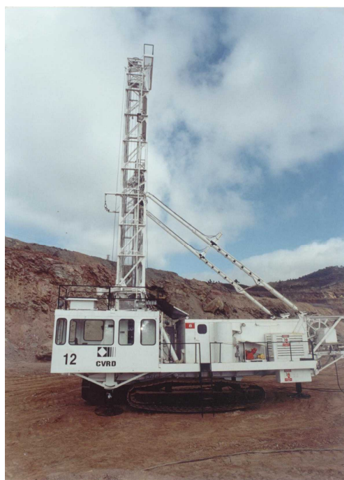
Figura 4.1 – Foto perfuratriz rotativa
