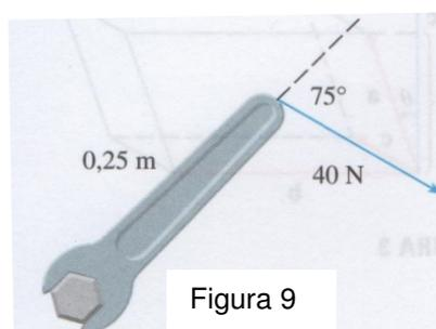
a) Determine o módulo do torque em relação ao centro do parafuso.
